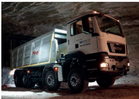
Untertageinsatz im Salzbergwerk: Transport von Versatzstoffen
