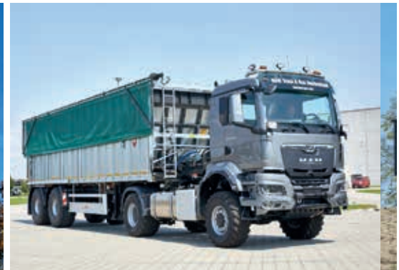
Toplift Light: Abdecknetz seitlich klappbar
