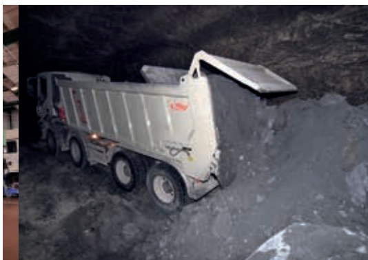
Untertageinsatz im Salzbergwerk: Transport von Versatzstoffen
