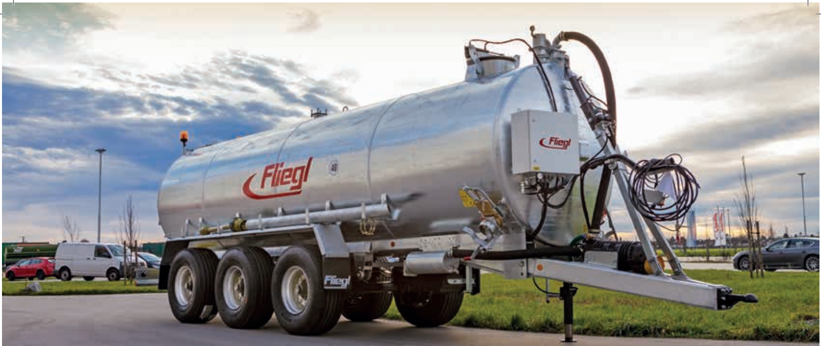
Wasserfass mit Schlauchhaspel und Regnerdüse
