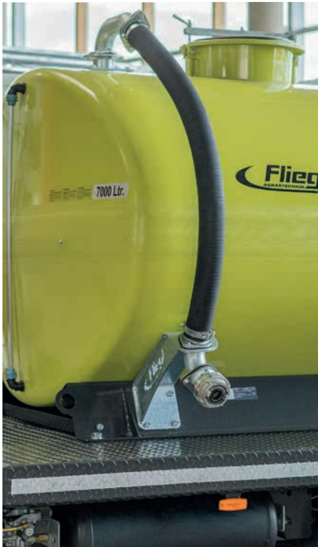
Befüllrohr für Hydrantenbefüllung
