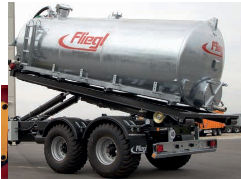
Fassaufbau als Abroller
