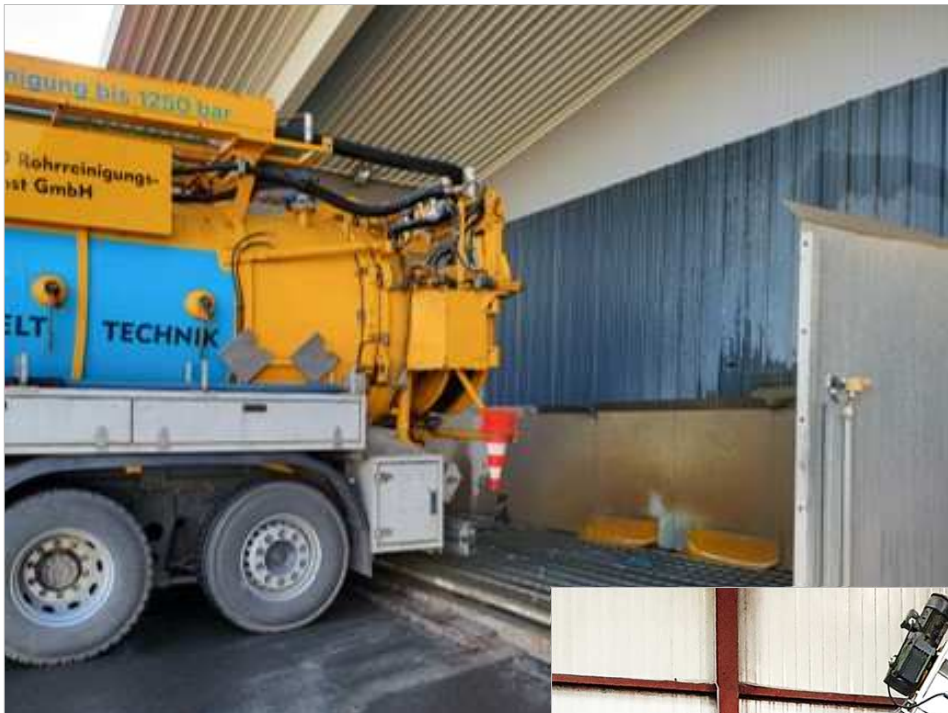
Kanalreinigungsfahrzeug - Entleerung an Recyclinganlage
