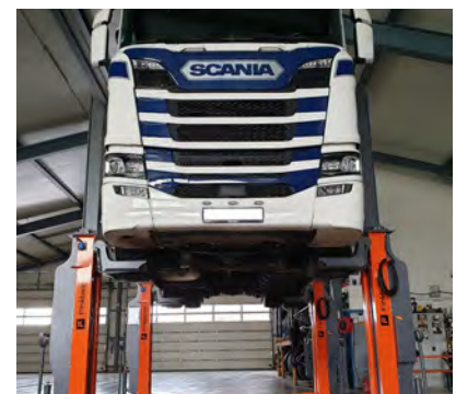
Völlig ohne Kabel: Batteriebetrieben arbeitet die mobile Radgreif-Hebeanlage EHB907V11DC von Finkbeiner.
