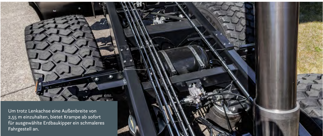
Eine hydraulische Zwangslenkung sorgt für eine deutlich bessere Manövrierbarkeit auf der Baustelle.
