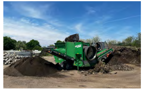
Multi Screen MS1600: Durch die Doppeltrommelsiebanlage werden natürliche Ressourcen geschont und ein höherer Anteil an wertvollen Stoffen gewonnen.
