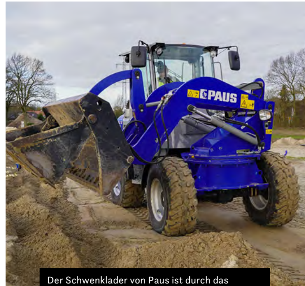
Der Schwenklader von Paus ist durch das um 180 Grad schwenkbare Hubwerk und die 40-Grad-Knicklenkung besonders flexibel in der Fahrzeugführung.
