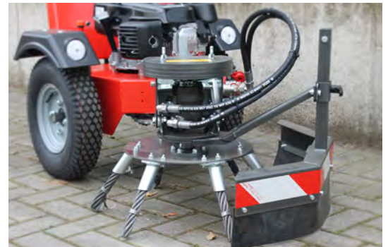
Die Wildkrautbürste mit einem Bürstentellerdurchmesser von 50 cm ermöglicht eine schnelle, chemiefreie Unkrautbeseitigung.
