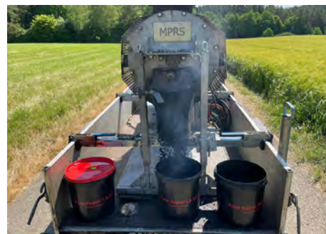
Die Aufbereitung der konzeptionell optimierten „Rohasphaltgranulate“ erfolgt mit einem patentierten Aufbereitungsgerät, das dem Anwender von der Firma Carl Ungewitter aus Bremen in verschiedenen Größen dauerhaft zur Verfügung gestellt wird.
