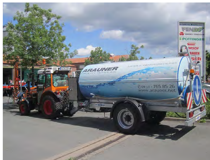
Mobile Bewässerung: ARAUNER Facility Services aus dem fränkischen Fürth setzt auf GFK-Tanks von Polyglas.
