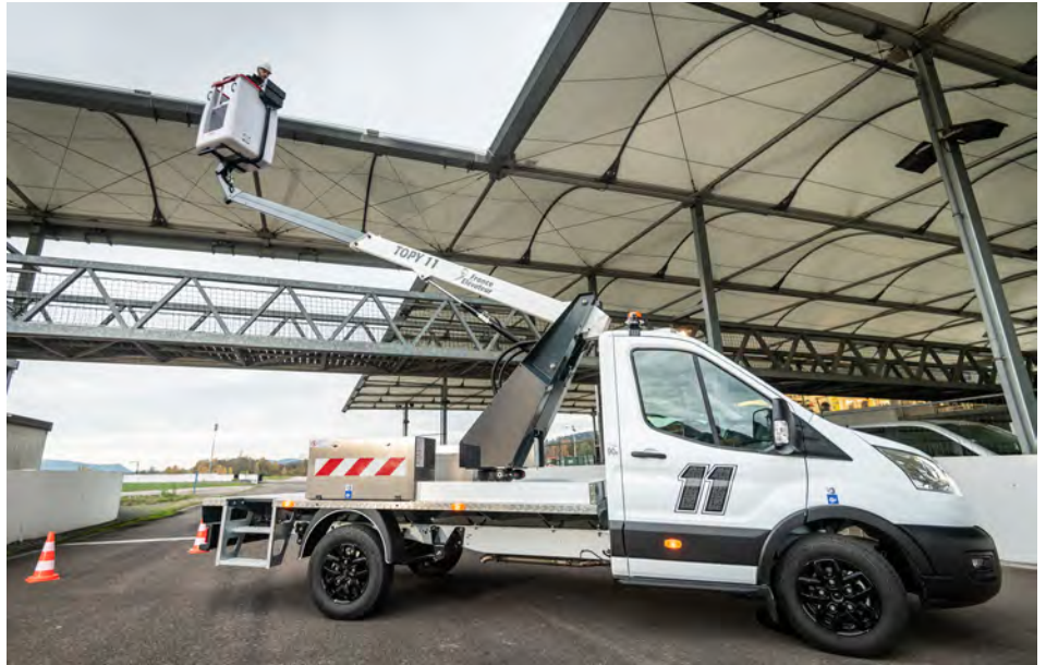
Ist im Einsatz genauso schnell, wie er aussieht: Der TOPY 11 kommt ohne Abstützung aus und ist sofort einsatzbereit für Arbeiten in elf Metern Höhe.
