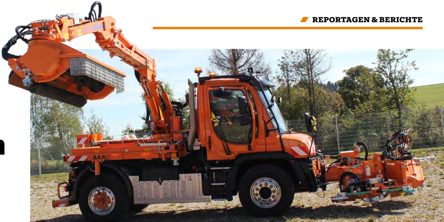
U 535 mit MHU 900 und MRM/MLM, sprich der neue Heckmäher mit 9,50 Metern Reichweite und Randstreifenmähergerät inklusive Leitpfostenausmähergerät.
