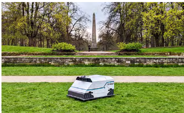
Das Gerät wiegt 60 kg, ist 120 auf 80 cm groß und reinigt bis zu 1.000 m 2 Fläche – je nach Verschmutzungsgrad.
