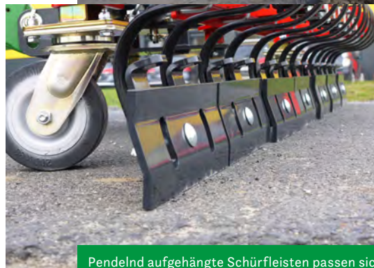
Pendelnd aufgehängte Schürfleisen passen sich unebenen Straßenverhältnissen bestens an.
