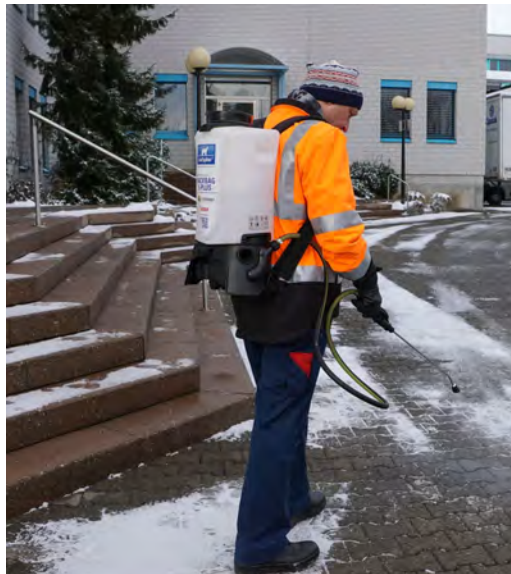
Zur manuellen Ausbringung von Eisfrei Perls in Kombi mit Sole eignet sich der Icefighter.
