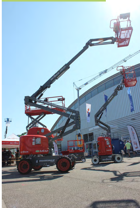
Unten: Neuerdings bieten die Sky- jack-Modelle SJ45 AJ+ und SJ60 AJ+ eine Tragfähigkeit von bis zu 454 kg.
