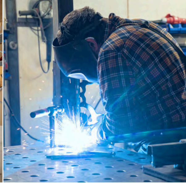
Abb. links: Max Bannaski, Geschäftsführer von BB-Umwelttechnik, hat die ersten Doppelmessermähbalken des Unternehmens im eigenen Bauernhof gebaut. | Abb. rechts: Für Produktionsreihen gibt es vor Ort Schweißroboter. Prototypen werden dagegen von Hand geschweißt.
