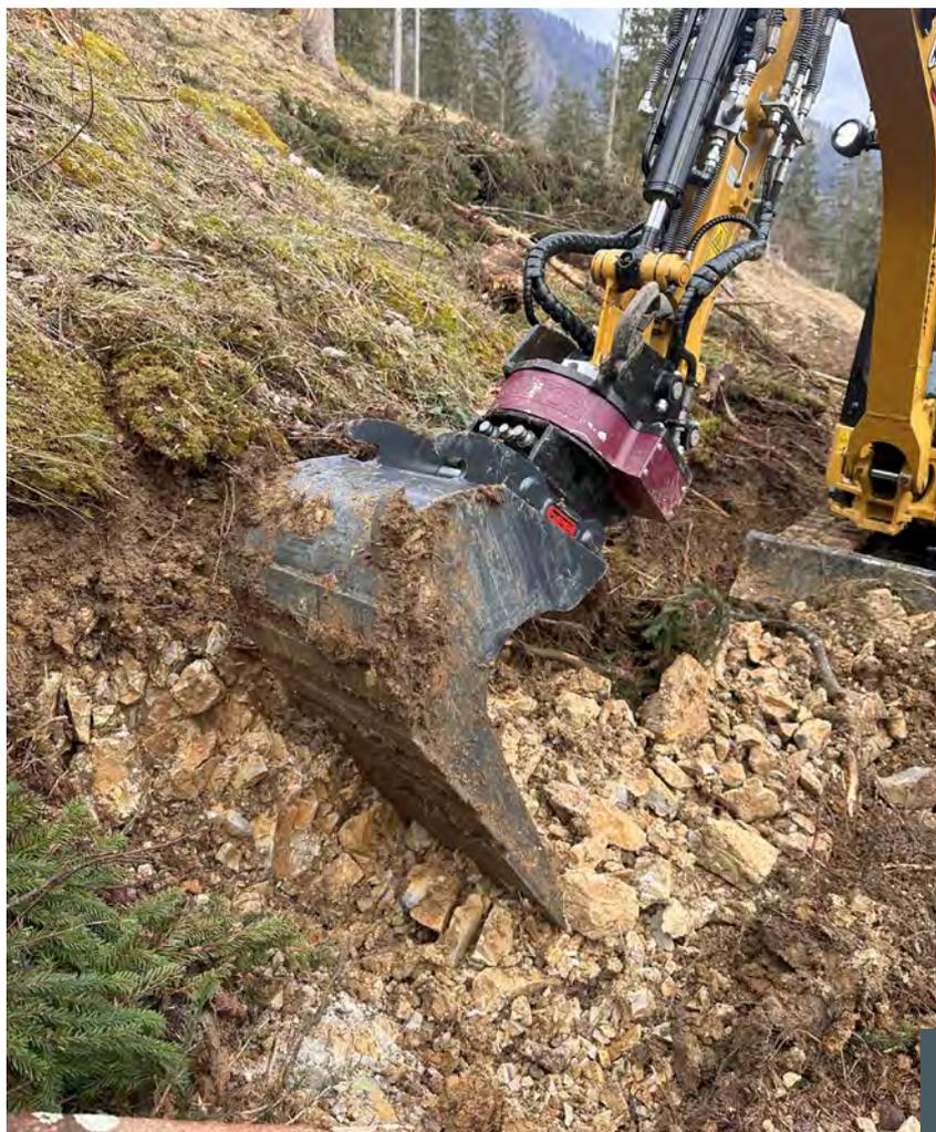
Die robuste, gekapselte Bauweise des RotoTop vermeidet Beschädigungen.
