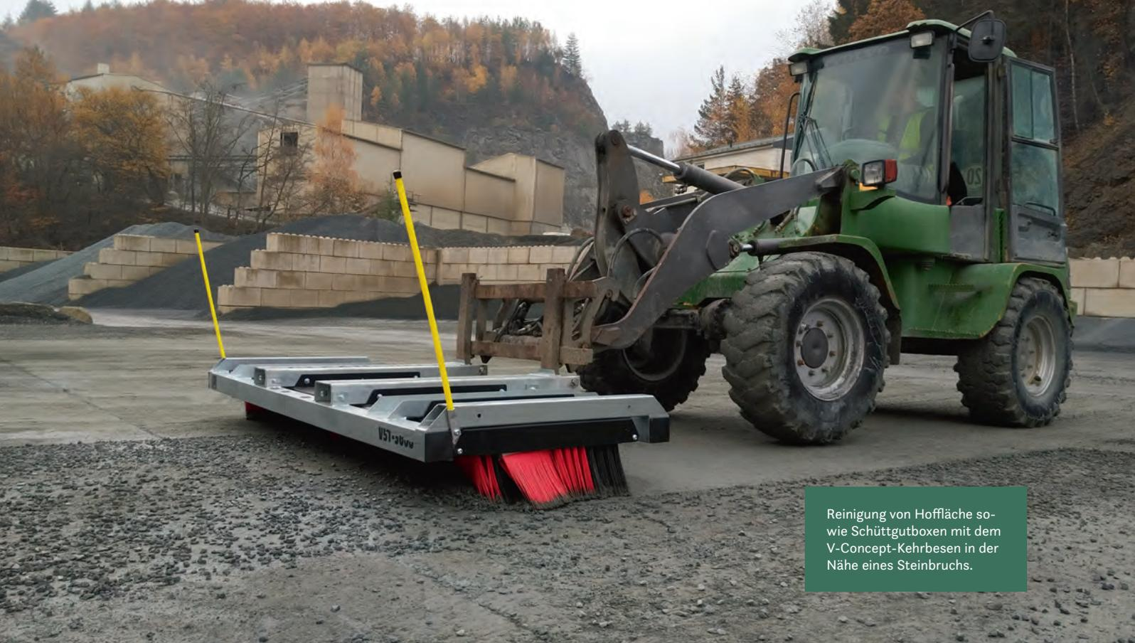
Reinigung von Hoffläche sowie Schüttgutboxen mit dem V-Concept-Kehrbesen in der Nähe eines Steinbruchs.
