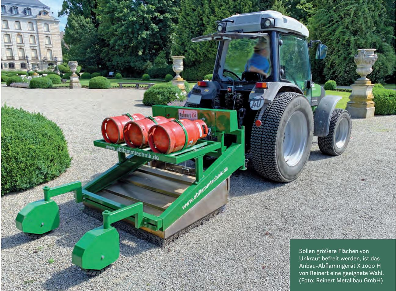
Sollen größere Flächen von Unkraut befreit werden, ist das Anbau-Abflammgerät X 1000 H von Reinert eine geeignete Wahl. (Foto: Reinert Metallbau GmbH)
