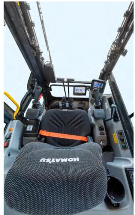
Bei langen Einsätzen absorbiert das Luftfederungssystem Stöße und Vibrationen und verringert Ermüdungs-Erscheinungen des Fahrers.
