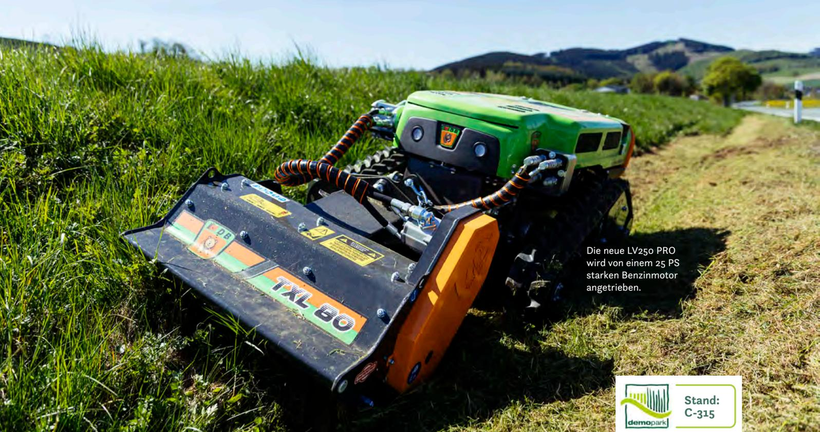
Die neue LV250 PRO wird von einem 25 PS starken Benzinmotor angetrieben.
