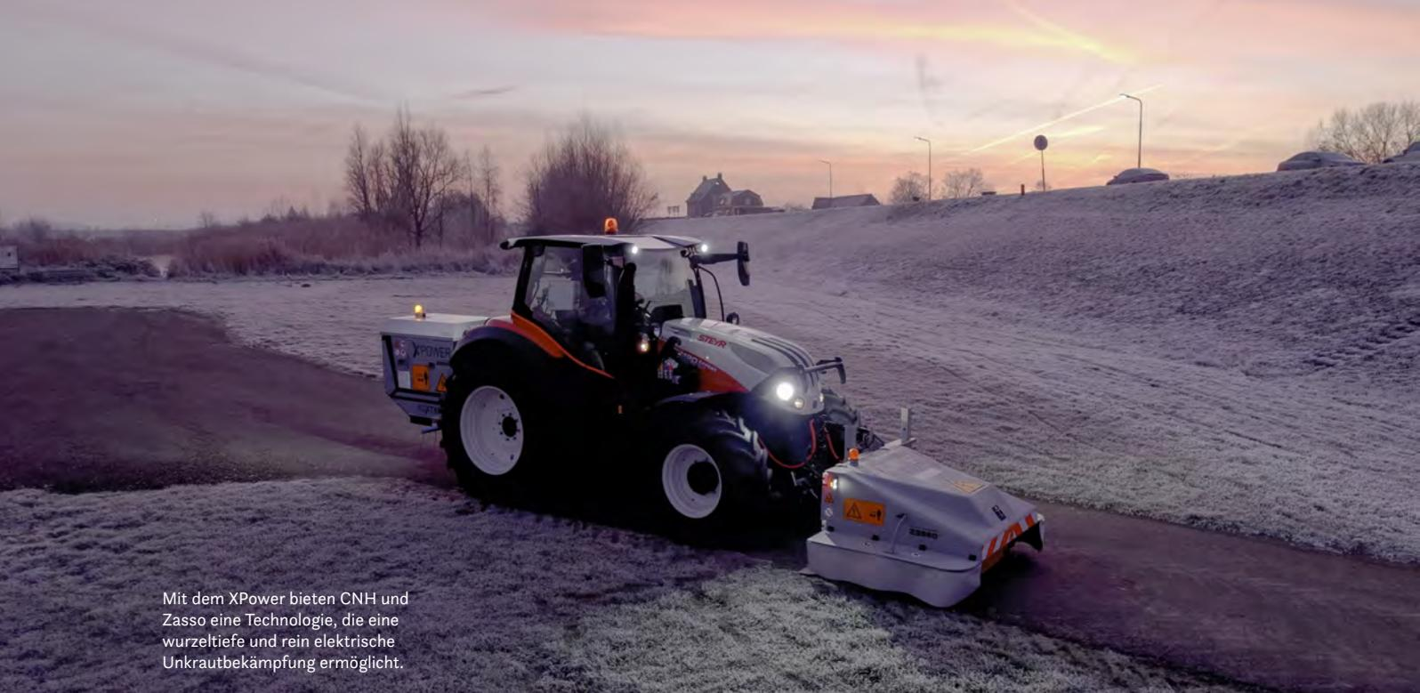
Mit dem XPower bieten CNH und Zasso eine Technologie, die eine wurzeltiefe und rein elektrische Unkrautbekämpfung ermöglicht.
