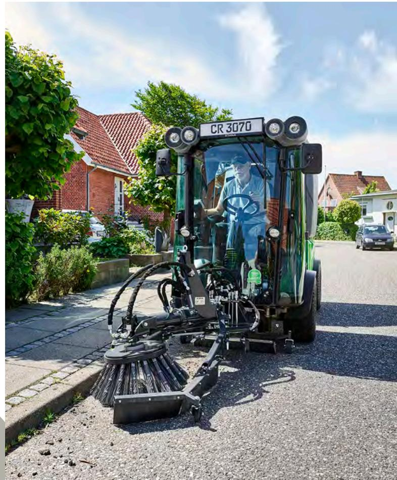
nimmt, erhält on top einen hydraulischen Seitenverschub, um ansprechende Kehrergebnisse in Kurven und Ausbuchtungen zu erzielen. Sinnvolles Feature bei Fiedler: Der Bürstenkopf kann in Schwimmstellung und mit Druck beaufschlagt arbeiten. Als Extra bieten die Sachsen zudem einen separaten elektro-hydraulischen Steuerblock sowie die Bedienung über 3D-Maus und Multifunktionsdisplay an.
