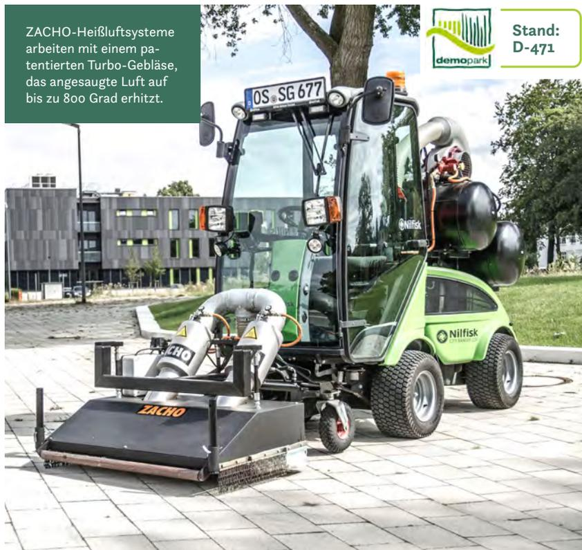
ZACHO-Heißluftsysteme arbeiten mit einem patentierten Turbo-Gebläse, das angesaugte Luft auf bis zu 800 Grad erhitzt.
