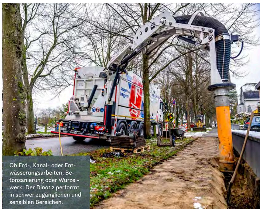
Ob Erd-, Kanal- oder Entwässerungsarbeiten, Betonanierung oder Wurzelwerk: Der Dino12 performt in schwer zugänglichen und sensiblen Bereichen.
