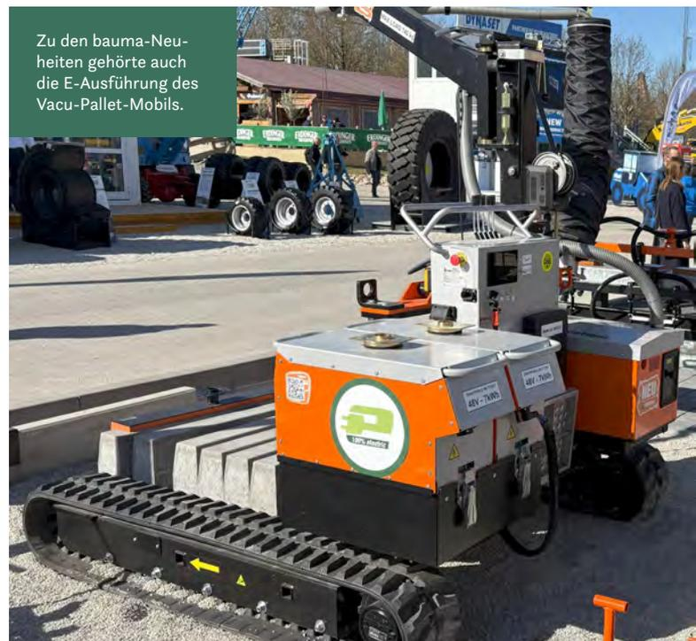
sieben kWh Leistung und bis zu fünf Stunden Laufzeit. Es können zwei Akkus am Mobil genutzt werden. So schafft die Maschine eine angenehme Arbeitsumgebung, weil kaum Arbeitsgeräusche zu hören sind.
