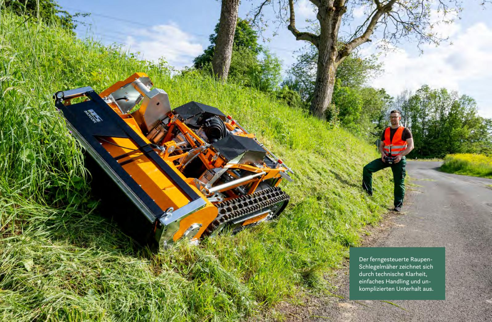
Der ferngesteuerte Raupen-Schlegelmäher zeichnet sich durch technische Klarheit, einfaches Handling und unkomplizierten Unterhalt aus.
