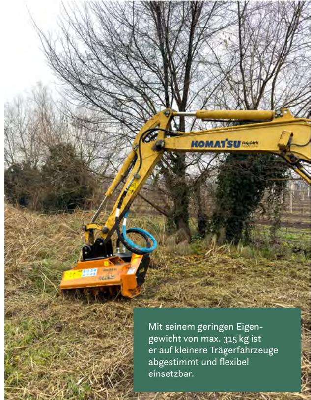
Mit seinem geringen Eigengewicht von max. 315 kg ist er auf kleinere Trägerfahrzeuge abgestimmt und flexibel einsetzbar.
