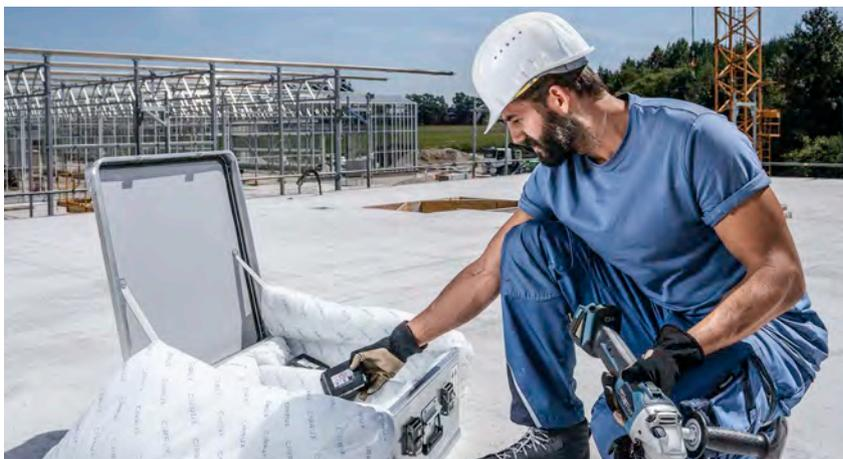
Für die sichere Aufbewahrung und den Transport von defekten Lithium-Akkus kommen Lager- und Transportboxen zum Einsatz.
