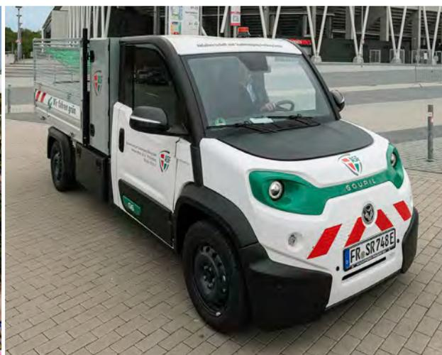
Abb. links: Der nur 1,10 Meter breite Goupil G2 ist ein Transporter, der gerade auf begrenzten Flächen lärm- und emissionsfrei die Arbeit mit entsprechenden Aufbauten unterstützen kann. (Fotos: Goupil Deutschland) | Bild rechts: Besonders im urbanen Umfeld kann der Goupil glänzen.
