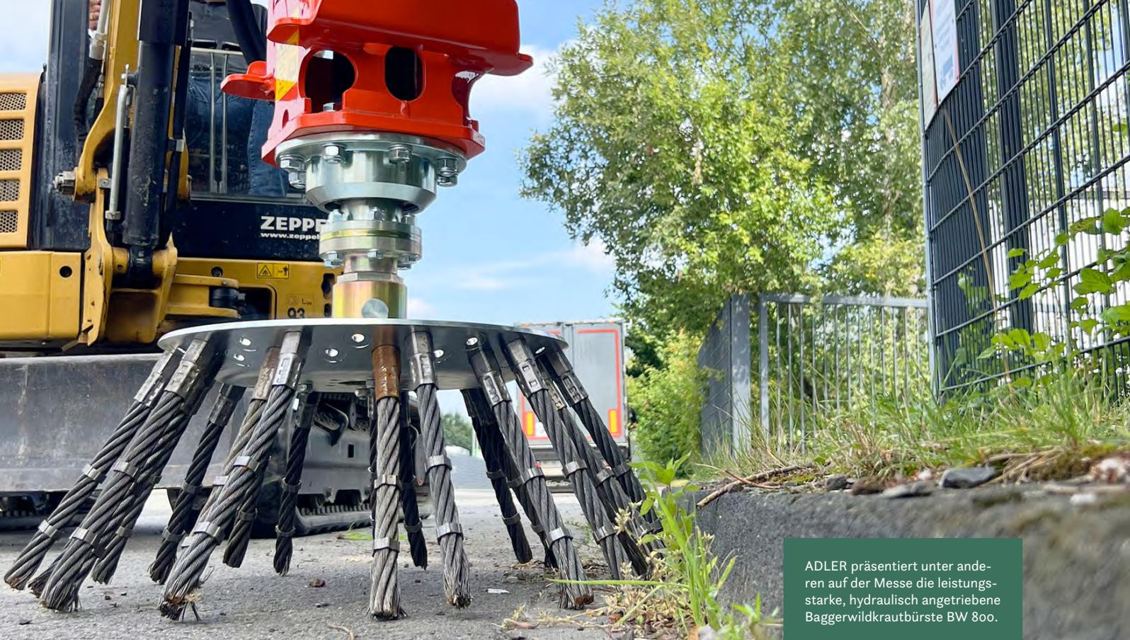
ADLER präsentiert unter anderen auf der Messe die leistungsstarke, hydraulisch angetriebene Baggerwildkrautbürste BW 800.
