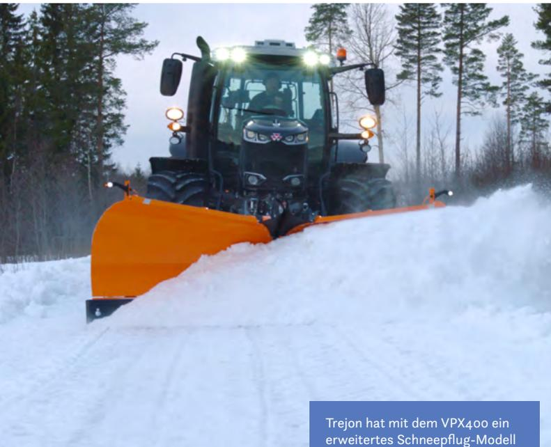
Trejon hat mit dem VPX400 ein erweitertes Schneeflug-Modell der VPX-Reihe mit einer Arbeitsbreite von 400 cm vorgestellt.
