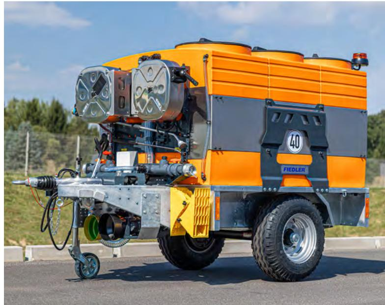
Das Herzstück der Wassertechnik bildet das FTS-Tanksystem, das mit seiner modularen Kaskadenbauweise und variablen Volumengröße von 230 bis 17.600 Litern eine gute Lösung für alle Fahrzeugtypen wie Lkw, Traktoren und Knicklenker darstellt.
