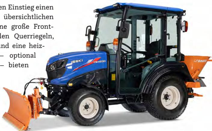
Durch seine komfortable klimatisierte Kabine ist die neue Kompakttraktoren-Baureihe TM 4 – hier mit Schneeschild und Streugerät – für den multifunktionalen Ganzjahreseinsatz geeignet.
