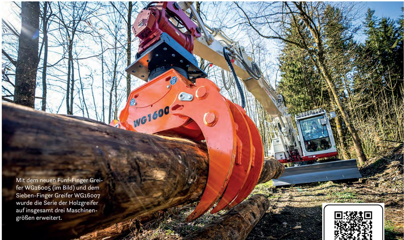
Mit dem neuen Fünf-Finger Greifer WG16005 (im Bild) und dem Sieben-Finger Greifer WG16007 wurde die Serie der Holzgreifer auf insgesamt drei Maschinengrößen erweitert.
