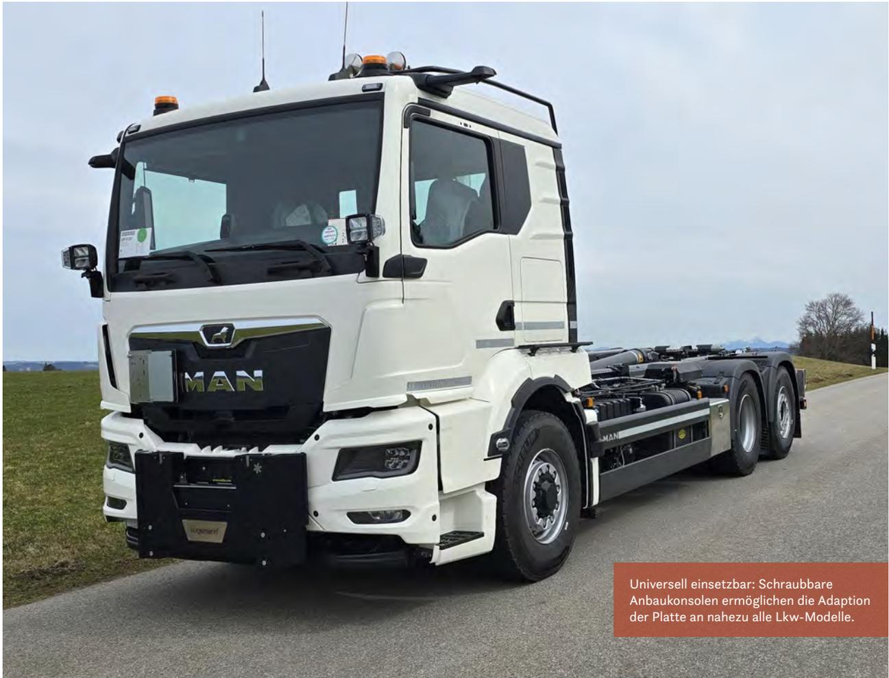
Universell einsetzbar: Schraubbare Anbaukonsolen ermöglichen die Adaption der Platte an nahezu alle Lkw-Modelle.
