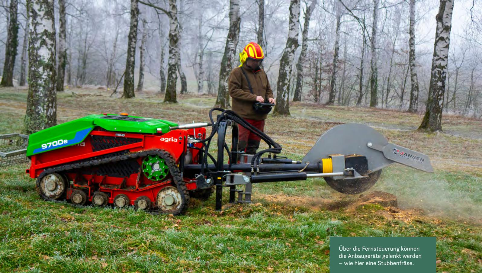
Über die Fernsteuerung können die Anbaugeräte gelenkt werden – wie hier eine Stubbenfräse.
