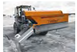
1,0 m³ Schaufel Drainagegräben füllen
