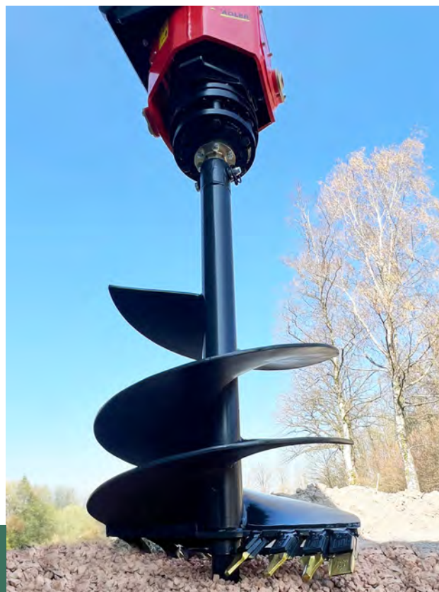
ADLER EHD im Einsatz: Heavy-Duty-Erdbohrer für kraftvolles Bohren in harten Böden.
