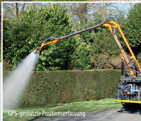
Exakte Steuerung der Wassermenge pro Pflanze
