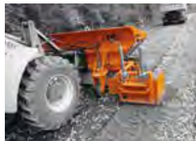
1,4 m³ Schaufel Materialeinbau direkt auf Höhe
