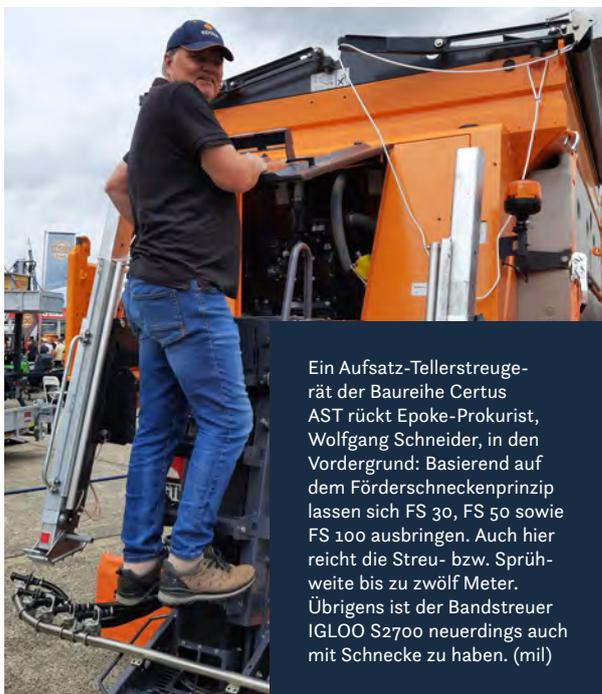
Ein Aufsatz-Tellerstreugerät der Baureihe Certus AST rückt Epoke-Prokurist, Wolfgang Schneider, in den Vordergrund: Basierend auf dem Förderschneckenprinzip lassen sich FS 30, FS 50 sowie FS 100 ausbringen. Auch hier reicht die Streu- bzw. Sprühweite bis zu zwölf Meter. Übrigens ist der Bandstreuer IGLOO S2700 neuerdings auch mit Schnecke zu haben. (mil)
