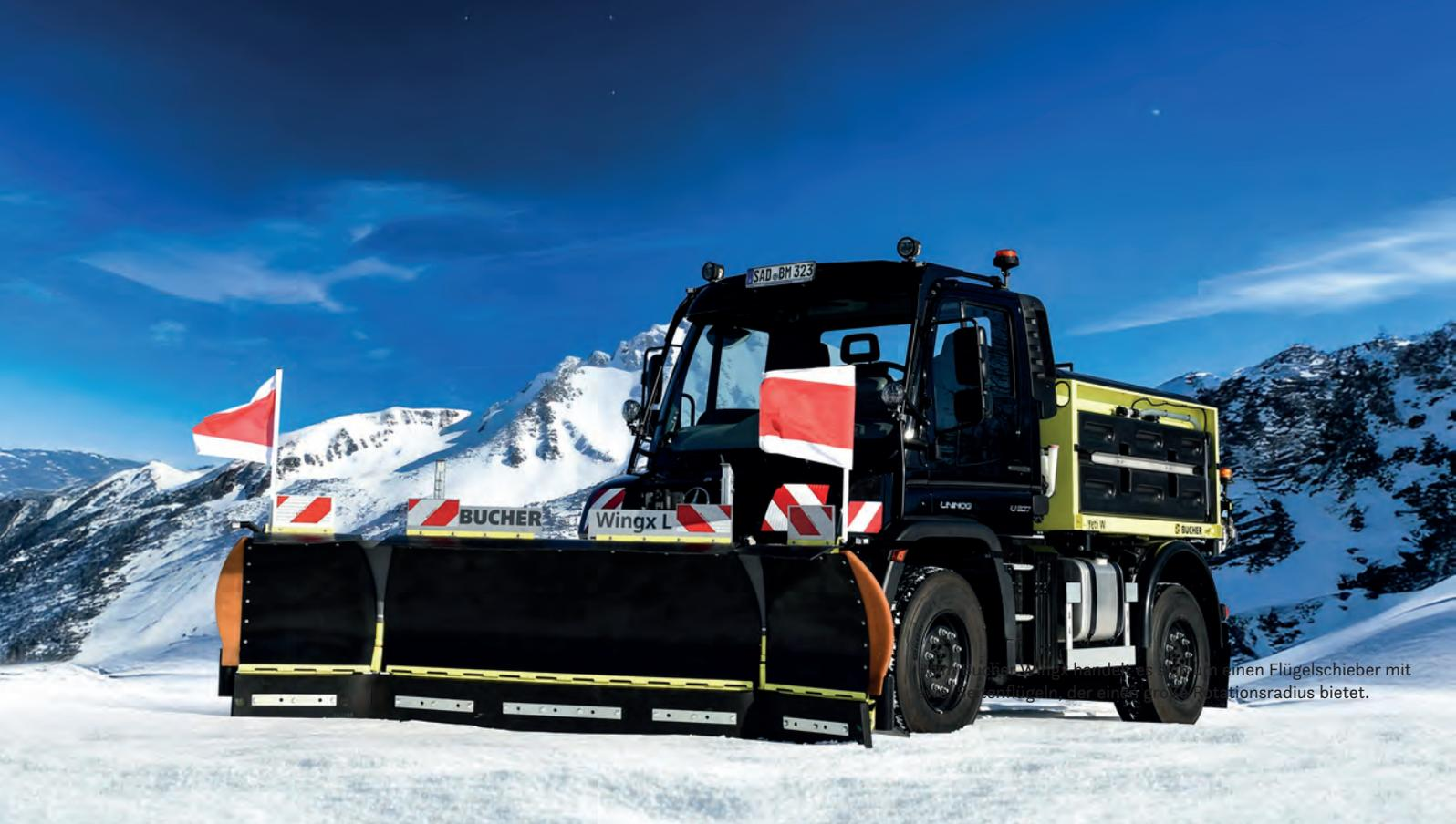
Das Bild zeigt ein handliches Bucher Wingx L als Flügelschieber mit zwei Flügeln, der einen großen Rotationsradius bietet.
