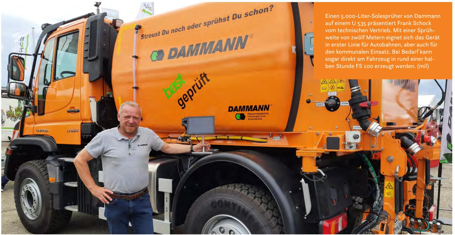
Einen 5.000-Liter-Solesprüher von Dammann auf einem U 535 präsentiert Frank Schock vom technischen Vertrieb. Mit einer Sprühweite von zwölf Metern eignet sich das Gerät in erster Linie für Autobahnen, aber auch für den kommunalen Einsatz. Bei Bedarf kann sogar direkt am Fahrzeug in rund einer halben Stunde FS 100 erzeugt werden. (mil)
