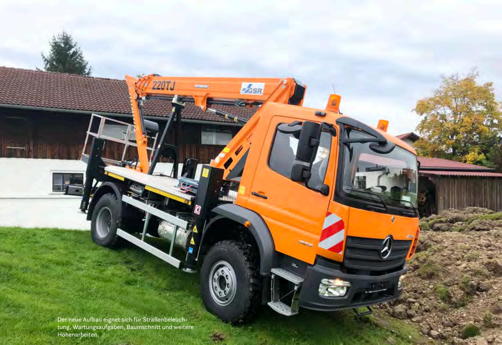
Der neue Aufbau eignet sich für Straßenbeleuchtung, Wartungsaufgaben, Baumschnitt und weitere Höhenarbeiten.
