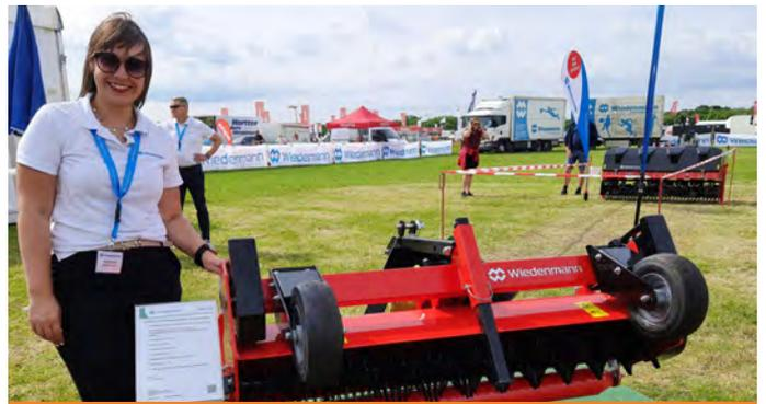
Verena Schäch, Wiedenmann-Marketing, legt den Fokus auf die neue Vertikutiereinheit TERRA V-Cut. Dabei bietet der „Alleskönner“ Arbeitsbreiten von 1,50 bzw. zwei Metern, bei einstellbarer Arbeitstiefe von bis zu 40 cm. Rasenfilz beseitigen, Scherfestigkeit steigern oder Wasserdurchlässigkeit sowie Gasaustausch erhöhen – alles inklusive. (mil)
