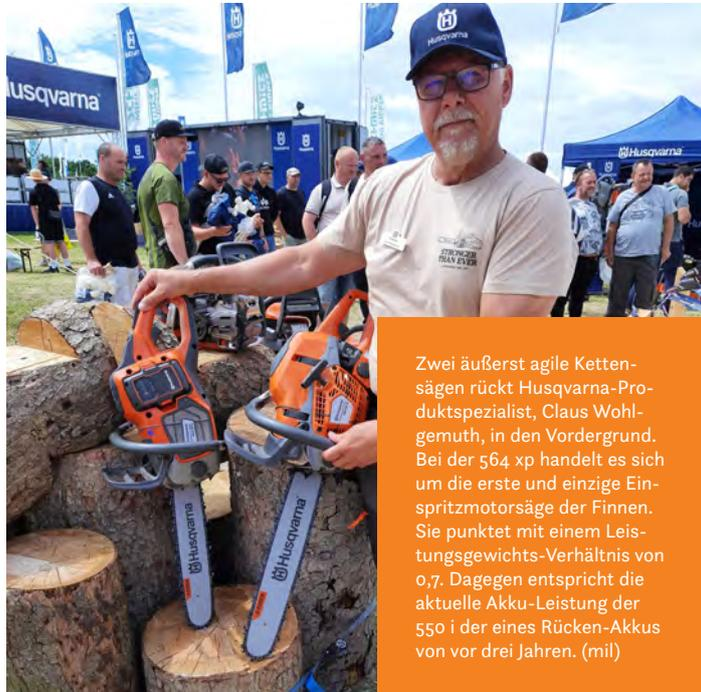
Zwei äußerst agile Ketten-sägen rückt Husqvarna-Produktspezialist, Claus Wohlgemuth, in den Vordergrund. Bei der 564 xp handelt es sich um die erste und einzige Einspritzmotorsäge der Finnen. Sie punktet mit einem Leistungsgewichts-Verhältnis von 0,7. Dagegen entspricht die aktuelle Akku-Leistung der 550 i der eines Rücken-Akkus von vor drei Jahren. (mil)
