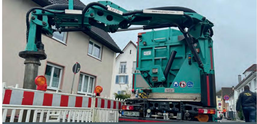
Je nach MTS-Saugbaggermodell und Einsatzzweck können drei unterschiedliche Kraftarm-Modelle ausgewählt werden: Power-, Mega- und Evo-Arm.
