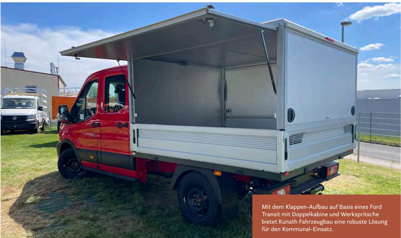
Mit dem Klappen-Aufbau auf Basis eines Ford Transit mit Doppelkabine und Werkspritsche bietet Kunath Fahrzeugbau eine robuste Lösung für den Kommunal-Einsatz.
