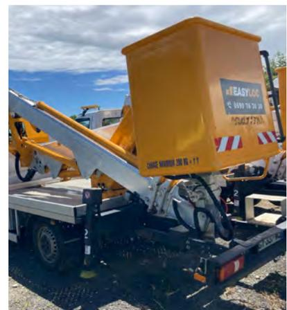
Auf 3,5-Tonnen-Fahrgestelle des Typs IVECO Daily wurden die Arbeitsbühnen montiert.
