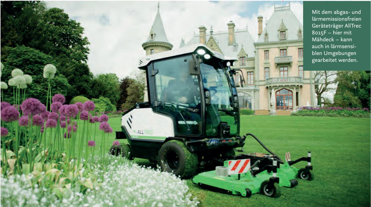
Mit dem abgas- und lärmmissionsfreien Geräteträger AllTrec 8015F – hier mit Mähdeck – kann auch in lärmsensiblen Umgebungen gearbeitet werden.
