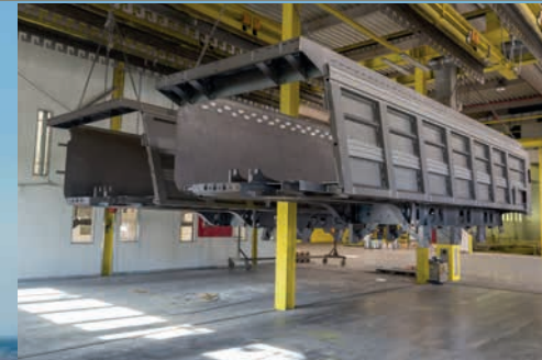
Lackvorbereitung durch Kugelstrahlen
