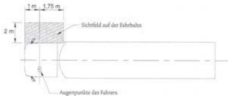
Abbildungen 10a und 10b: Sichtfeld eines Nabbereichs- oder Anfahrspiegels der Gruppe V
