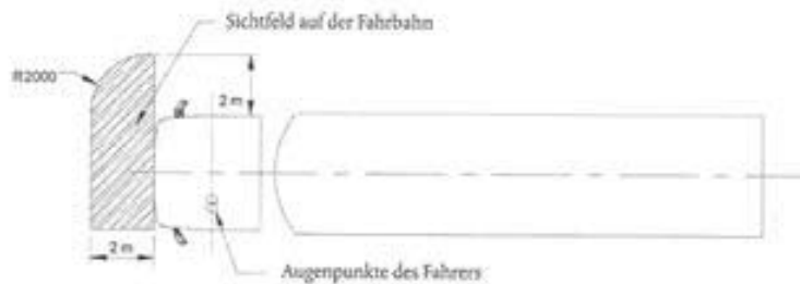
Abbildung 11: Sichtfeld eines Frontspiegels der Gruppe VI
