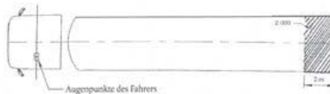
Abbildung 12: Sichtfeld von Sichthilfen für das Fahrzeugheck
