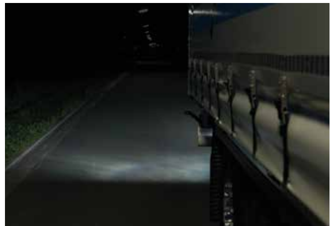
Ausleuchtung mit zusätzlichen Rückfahrcheinwerfern
