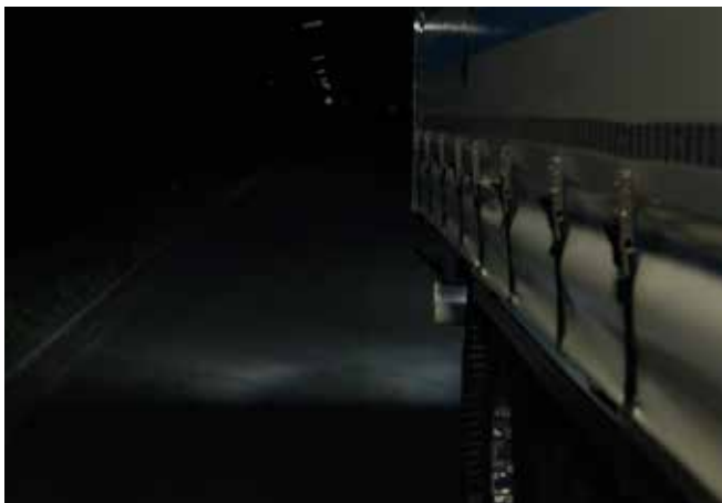
Ausleuchtung ohne zusätzliche Rückfahrcheinwerfer
