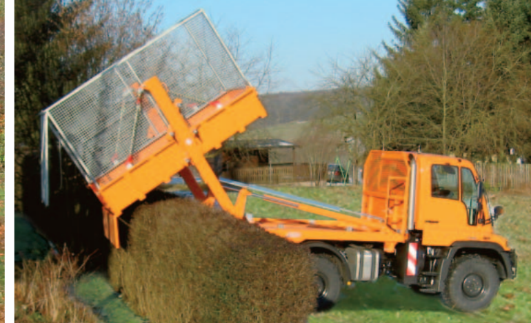
Sand, Kies, Humus, Rindenmulch, Garten- oder Pflanzenabfälle werden hydraulisch gekippt oder über einen Zaun, eine Hecke hinweg oder in einen größeren Container hochausgekippt .
