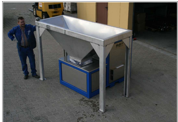
MoBi15/22 mit Erweiterungstrichter zur Befüllung mit Radlader oder BigBag
