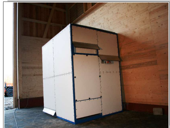
Aufstellungsbeispiel MoBi 37/55 in einer Schüttguthalle zur Silobefüllung. Ansicht mit Bedientastatur
