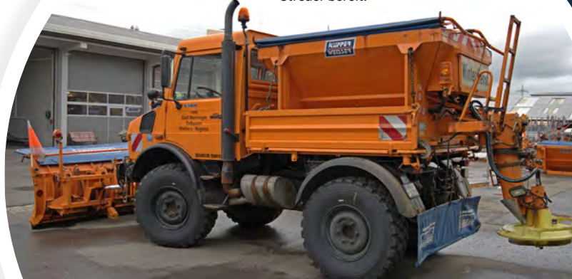
Im Außenbereich steht ein Unimog U 1400 mit Schmidt-Schneeschild und Küpper-Weisser-Streuer bereit.
