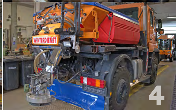
1: Eine Swingo 200-Kehrmaschine von Aebi Schmidt eignet sich z.B. für den Einsatz im engen Stadtzentrum. | 2: Um die Streumenge bestmöglich bestimmen zu können, verlässt sich die Bauhof-Leitung auf moderne Sensorik. | 3: Das viele Holz wird in einer betriebseigenen Schreinerei verarbeitet. | 4: In der Werkstatt wurde unlängst ein Unimog mit einem Kugelman-Streuer ausgestattet.
