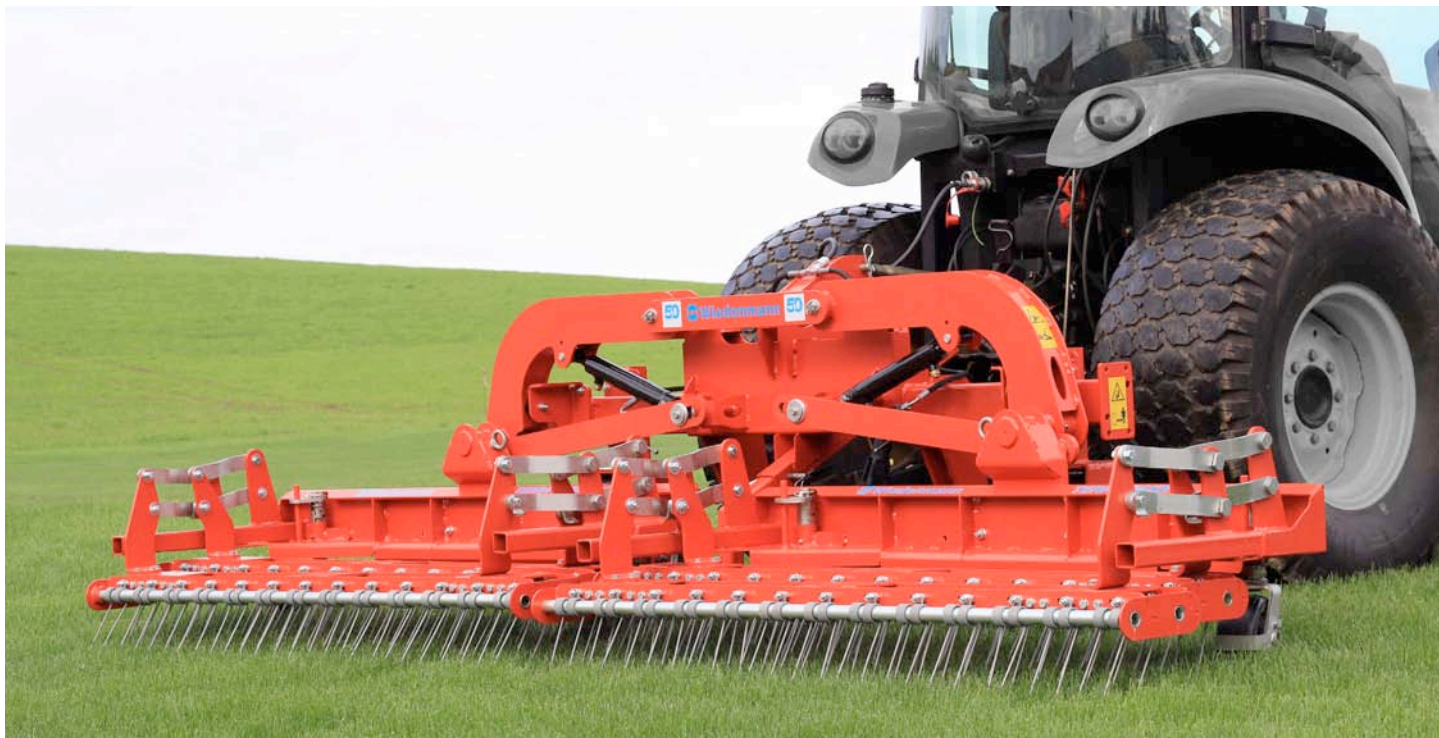
Neue Flächenstriegel von Wiedenmann: Die Maschinenserie Terra Rake bietet jetzt Arbeitsbreiten von 170 bis 460 cm. Im Bild das Modell mit 350 cm, die über zwei hydraulische Ausleger erzielt werden. Die kleineren Modelle sind einteilig konstruiert.
