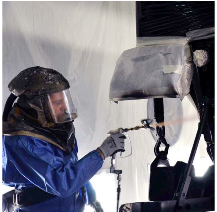
Mit einer professionellen Konservierung, bestehend aus Hohlraum- und Unterbodenschutz bzw. Oberflächen- und Lackschutz, wird Rost verhindert und die Qualität der Geräte und Fahrzeuge gesteigert. Bild-Quelle: ISEKI
