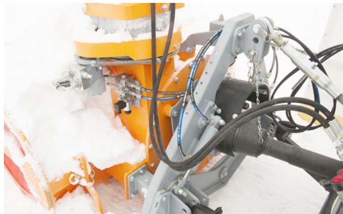
Mechanische Zapfwelle für einen leistungsstarken und effizienten Antrieb der Schneefräse.
