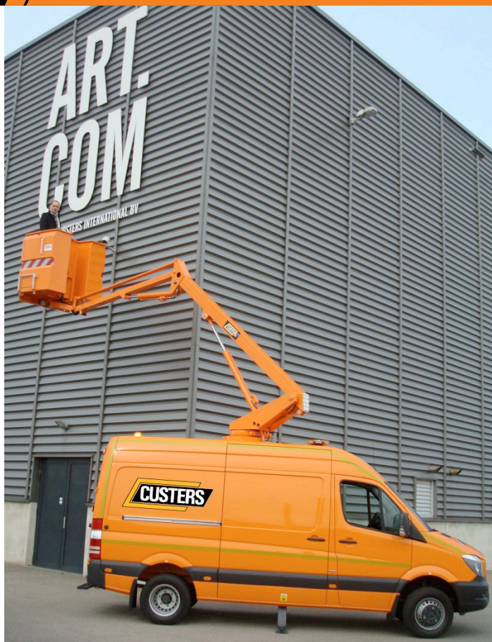
Custers Hydraulica BV hat Anfang April 2015 wieder eine neue 12m Hubarbeitsbühne auf Kastenwagen, die Taurus 230-12MV, abgeliefert.
