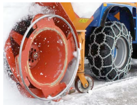
Für Profis - Ketten von RUD für den harten Einsatz. Die Profilgreifsteg setzt auf Profilstege zur Steigerung der Traktion.
