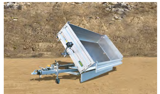
Echter Allrounder: Der Maschinentransporter-Zweiseitenkipper, Typ DUO, ist ein Pritschenhochlader mit nach hinten kippbarer Ladefläche sowie ein Seitenkipper zugleich.
