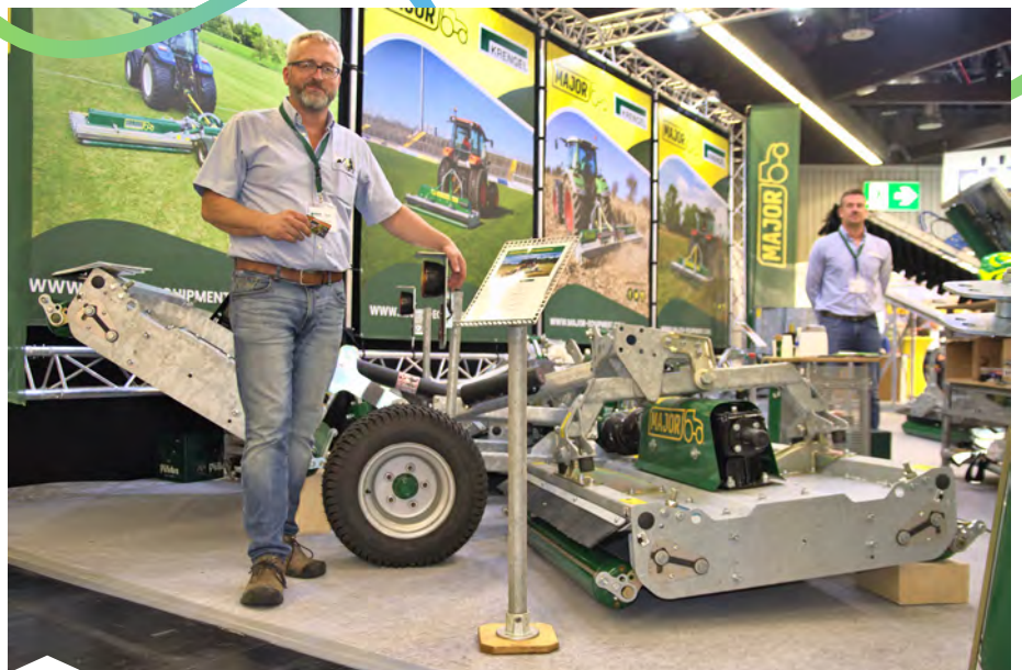
Hubertus Krengel, Firmenchef der Krengel Landtechnik GmbH, am Sichelmulcher Contoura. Durch ein spezielles Sichelmähwerk wird eine Sogwirkung der Maschine vermieden, sodass Insektenpopulationen trotz intensiven Arbeitens geschont werden.
