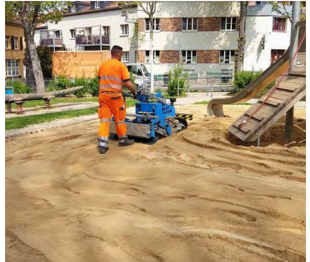
Die „Baby Tapiro“ siebt den Sand und sondert unerwünschte Anteile aus.
