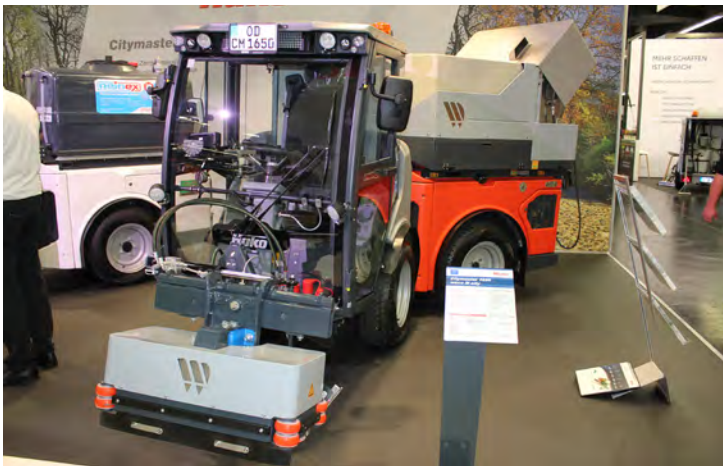
Hakos Citymaster 1650 weco M city: bringt permanent 98,6 Grad und ist als mobiler Hochdruckreiniger einsetzbar.
