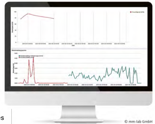
Abb. oben: „smart KOMPAKT“ für die Stadtgrünbewässerung übernimmt die Bäume aus dem Kataster, gibt Empfehlungen basierend auf Wetterprognosen, Niederschlagsmengen und Bodenfeuchte-Werten und steuert die Wassermenge, die nach jeweiligem Bedarf ausgegeben werden soll.
