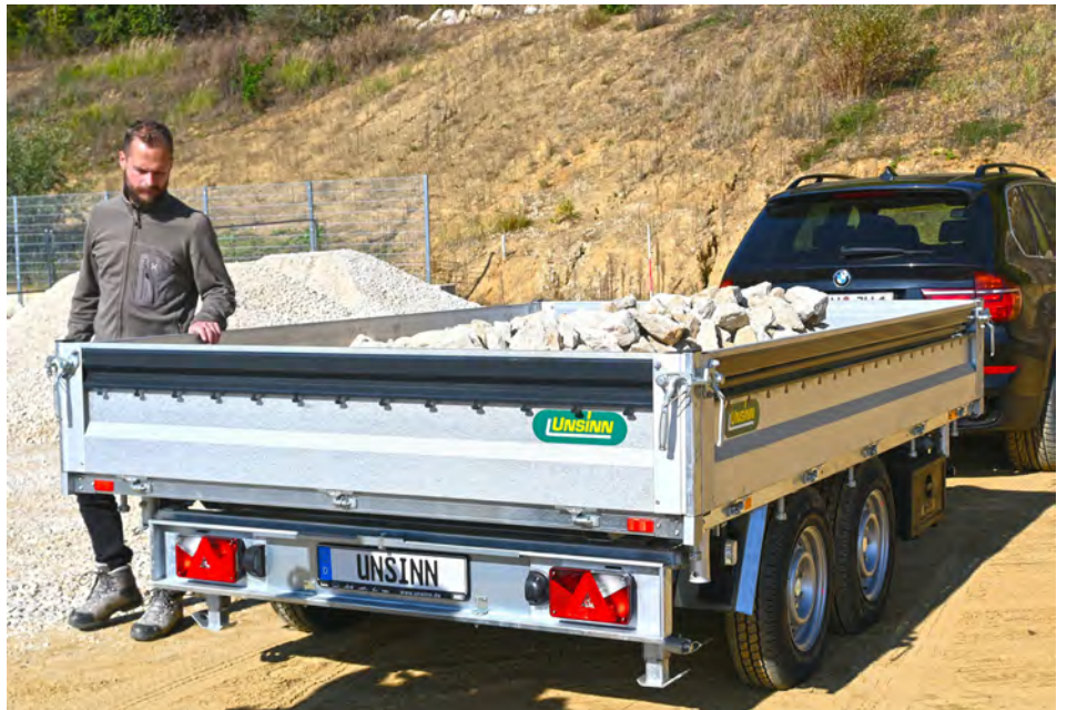
Der neue Dreiseitenkipper, Typ UDK-S, mit Stahlbordwand sowie integrierter Netz- und Planenleiste ist für härteste Einsätze konzipiert und ergänzt die UDK-Anhängerserie von UNSINN.
