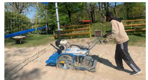
Mit der CICALA-Reinigungsmaschine der ALPINE-SABEL GmbH können Sandflächen schnell gereinigt werden.
