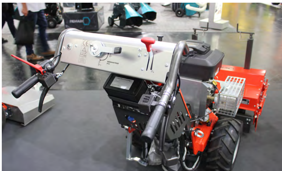
Neu bei den Arealmaschinen von Kersten ist die Holm-Aktiv-Lenkung beim Einachser UBS Hydro.
