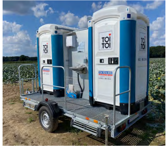
Mit einer Größe von 3.530 auf 1.790 mm und einem zulässigen Gesamtgewicht von 1,5 Tonnen bietet die Einachser-Version von Böckmann, der MTK 3517/15, Platz für zwei Dixis.
