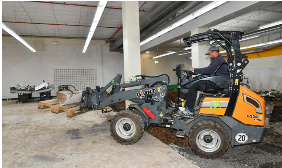
Der E-Radlader von Giant zeichnet sich durch Geländegängigkeit auf jedem Untergrund aus. (Fotos: Dieter Göllner)
