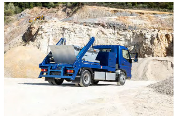
Auch konventionelle Schüttgutcontainer können transportiert und dank der teleskopierbaren Hubarme über Hindernisse befördert oder in andere Container hochausgekippt werden.
