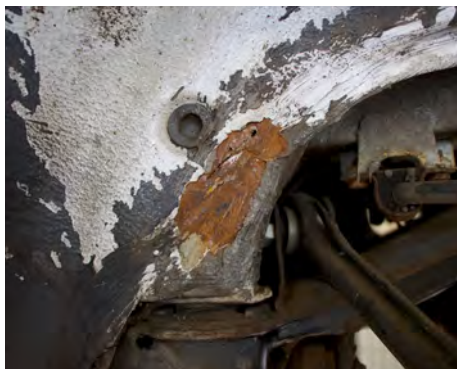
Rost ist vor allem bei kommunalen Fahrzeugen problematisch, da diese durch die enormen Belastungen, wie beispielsweise Streusalz, extremen Beanspruchungen ausgesetzt sind.
