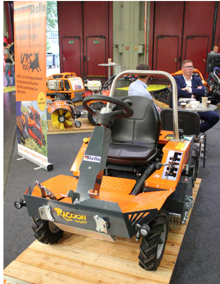
Der neue Aufsitz-Schlegelmulcher Racoon 85 SMART verfügt über eine elektromagnetische Messerkupplung, die die Messerwelle sanft zuschaltet und innerhalb der geforderten Zeit abstoppt.
