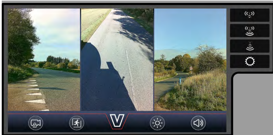
Das System zeigt drei Ansichten: die linke, die rechte und die hintere Kameraperspektive. Kameraansichten und akustische Benachrichtigungen können während der Fahrt geändert werden.
