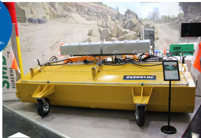
Bereits für Zeppelin gebrandet: die neue BKM Maxi von Sobernheimer, die als 2,70-Meter-Variante eine Außenbreite von knapp drei Metern aufweist und somit auch auf öffentlichen Straßen eingesetzt werden kann.
