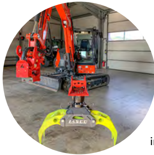
Minibagger werden von Bernd Waltz gerne gleich inklusive vollhydraulischem Schnellwechselsystem von Lehnhoff vermietet.
