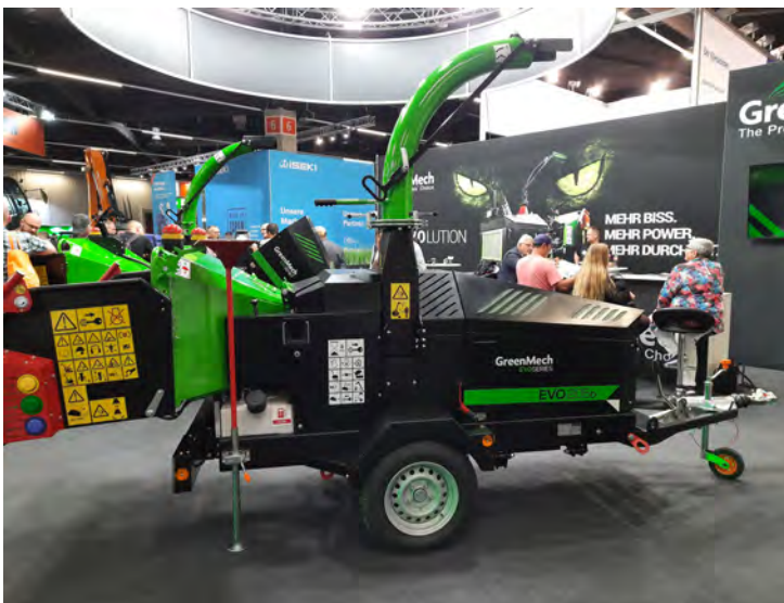
GreenMechs neue Häcksler-Produktreihe mit der Bezeichnung EVO bietet nun breitere Einzugswalzen, sodass auch buschiges oder nasses Material effizient eingezogen wird.
