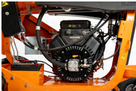
Die Maschine bietet einen 18-PS-Zweizylinder-Vanguard-Motor.
