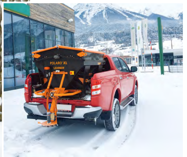
Der POLARO XL bietet circa 720 kg Fassungsvermögen und mit optionalem Behälteraufsatz sogar 1.000 kg – wie hier im Bild zu sehen.
