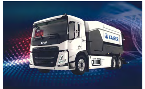
AquaStar EV: das laut Hersteller weltweit erste vollelektrische Kanalreinigungsfahrzeug mit Wasserrecycling.
