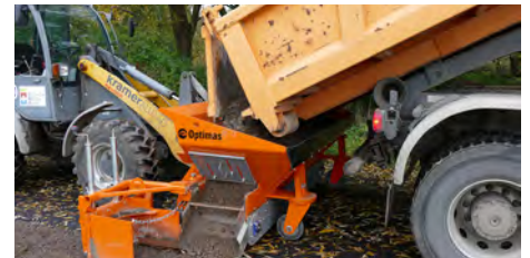
Abb. oben: Die Optimas Finliner-Material-Verteilschaufel kann direkt vom Lkw aus beladen werden und sorgt für eine hohe Arbeitsgeschwindigkeit bei der Bankettpflege.
