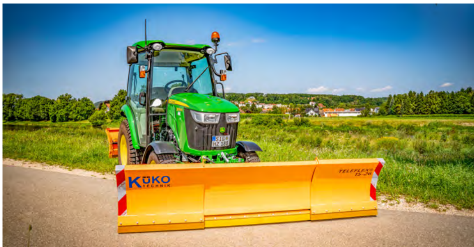
Vor allem die Möglichkeit, während der Fahrt die Räumbreite hydraulisch fast zu verdoppeln und damit jede Räumaufgabe flexibel und mit Zeitersparnis zu meistern, überzeugte die Jury.
