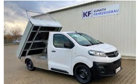
Beim abgebildeten Fahrzeug ist eine 75-kW-Batterie mit bis zu 328 km Reichweite nach WLTP verbaut.
