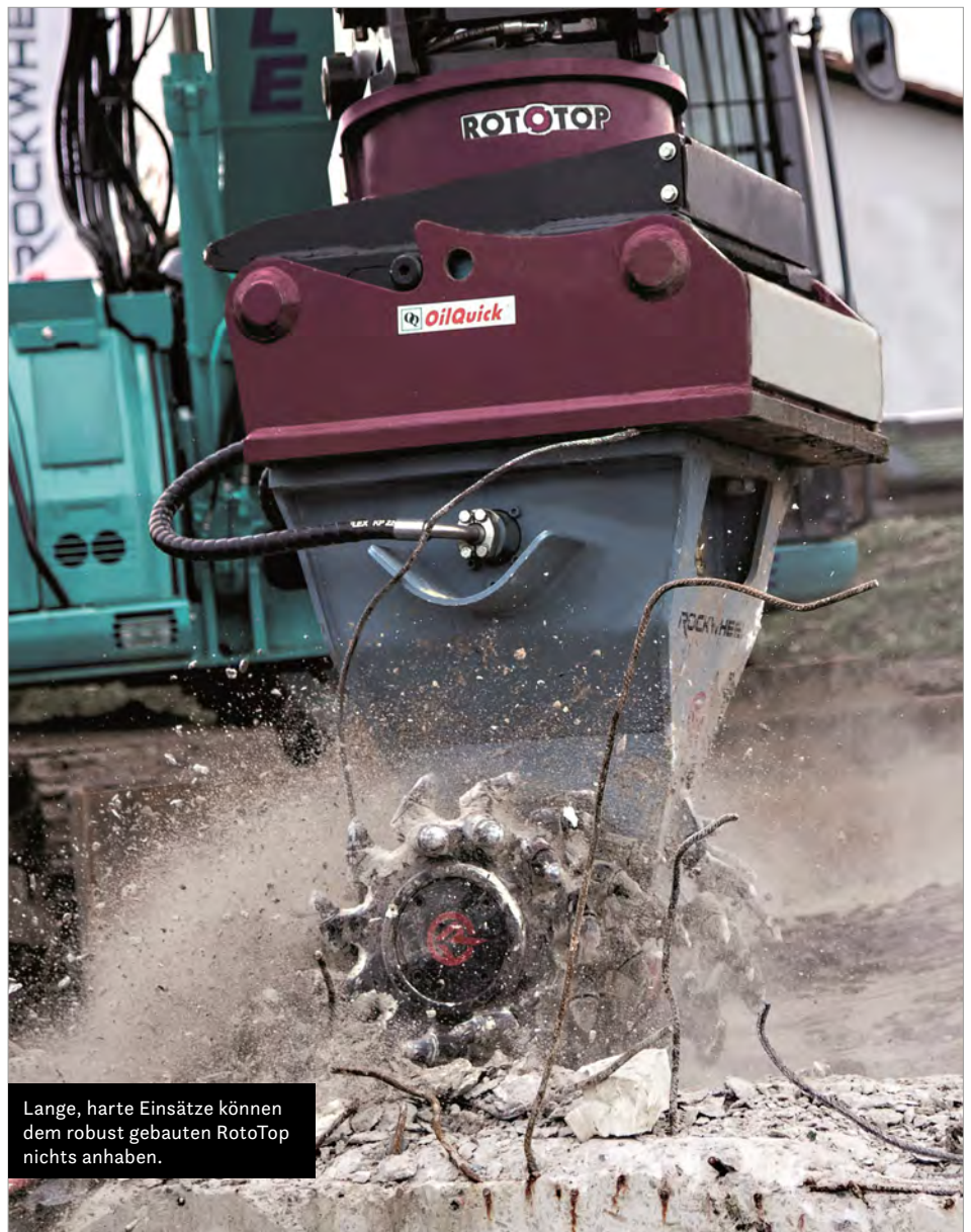
Ausgebaute Range der RotoTop – sie sind für Bagger mit einem Einsatzgewicht von 600 kg bis 45 Tonnen verfügbar.
