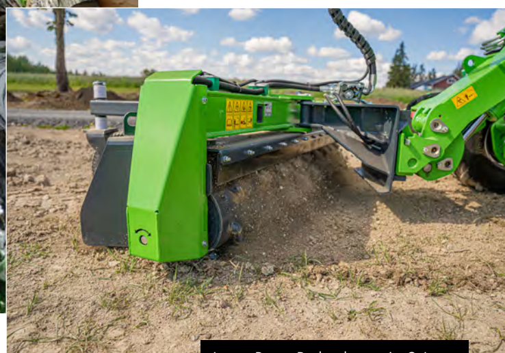
Avants Power-Rechen kommt im GaLa-Bau und bei der Grundstückspflege zum Einsatz, bei der Vorbereitung von Saatbeeten, dem Begradigen von Split- und Schotterstraßen sowie dem Reinigen und Einebnen verschiedener Arten von Untergründen.
