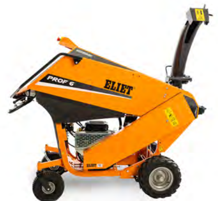
Wie andere Modelle des Unternehmens ist der Häcksler mit dem sogenannten „Axt-Prinzip“ ausgestattet, bei dem die Klingen in Richtung der Holzfasern spalten.
