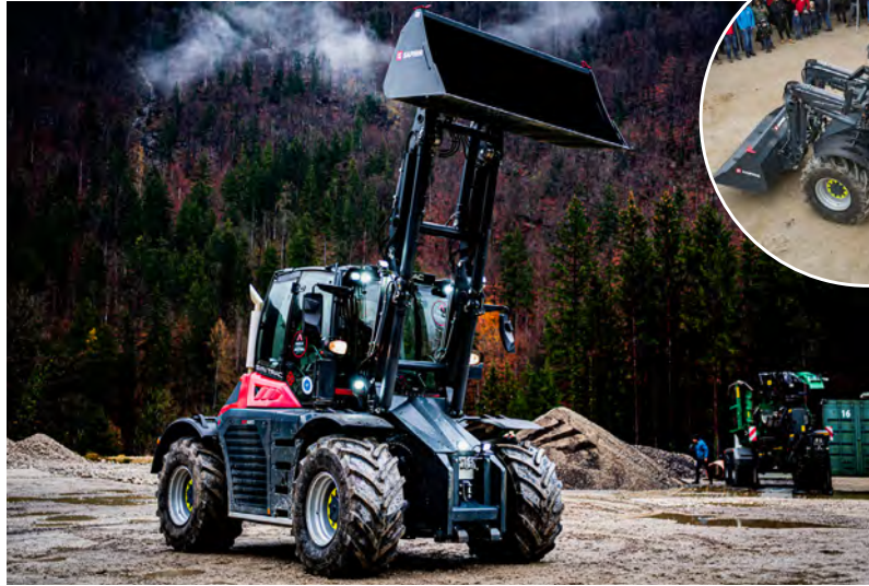
Abb. großes Bild: Die hohe Schubkraft des Frontladers wird durch Abstützung der Schaufel an der Fahrzeugfront erzielt. (Fotos: SYN TRAC) | Bild im Kreis: Unter anderem beim Forst- und Straßenbautag wurde der Frontlader der Öffentlichkeit präsentiert. Hier wird die Auskipphöhe von 4,50 Meter dem Publikum demonstriert.
