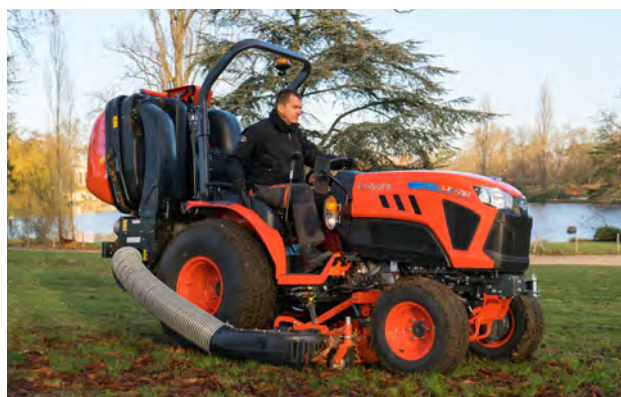
Der elektrische Kompakttraktor Kubota LXe-261 (26 PS) fährt geräuscharm und abgasfrei durch Parkanlagen von Paris.
