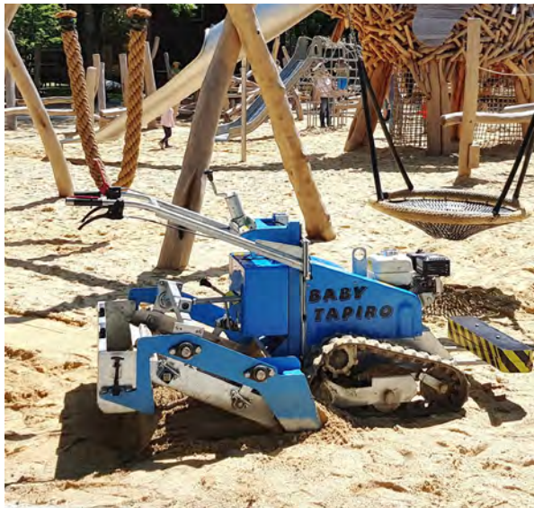
Ursprünglich für den Einsatz an Badestränden entwickelt, eignet sich die Baby Tapiro seit geraumer Zeit auch für die Reinigung von nassem Sand auf Spiel- und Sportplätzen.
