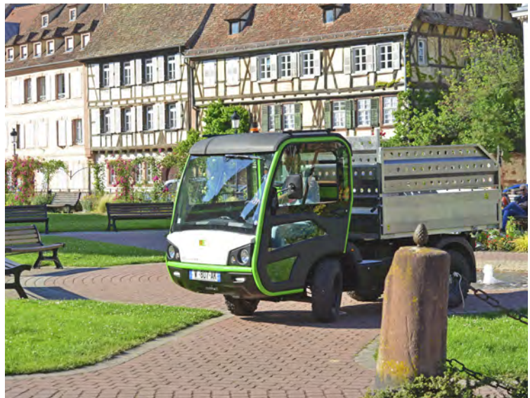
Mit seinen 3,72 Metern Länge ist der ET Lander sehr kompakt. Die integrierten Laderampen ermöglichen das Laden von Geräten.
