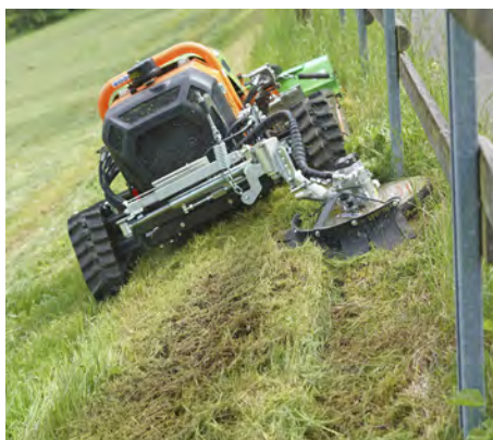
Durch einen zusätzlichen Anbauadapter im Heck des Geräteträgers kann die MDB-Funkraupe nun mit einem DRAGONE-Randstreifenmäher ausgestattet werden. (Abb. links) | Dank dem äußeren Spezialgummikranz kann randnah gemäht werden. (Abb. rechts)
