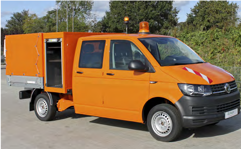
Ein VW-Transporter mit Schoon-Mittelhochpritsche , Gerätekasten, Plane, Spritze, Ausstellklappe, RKL sowie Schwerlastauszug.
