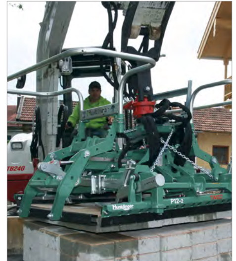
In diesem Jahr sind zwei ganz neue Varianten der hydraulischen Ansteuerung hinzugekommen, die zunächst für die Modelle P01 und P12 (Foto) zusätzlich von Hunklinger angeboten werden.
