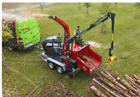
Der Häcksler Cheetah 30/80 bietet mit seinem 3,5-Tonnen-Pkw-Fahrgestell und eigenem Kran sehr große Flexibilität. (Links) Von dem übersichtlichen Bedienstand aus lässt sich der Kran mit 4,2 Meter Reichweite per Kreuzhebelsteuerung oder optional per Funk bedienen. (Rechts)
