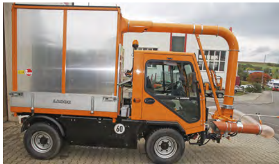
Das Laubverladegebläse vom Typ F648 von Fischer Maschinenbau ist hier auf ein Ladog-Trägerfahrzeug aufgebaut.
