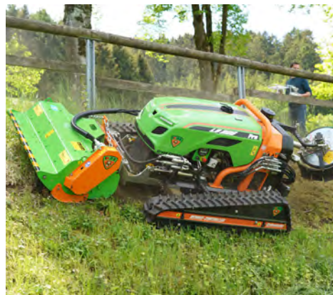
Durch einen zusätzlichen Anbauadapter im Heck des Geräteträgers kann die MDB-Funkraupe nun mit einem DRAGONE-Randstreifenmäher ausgestattet werden. (Abb. links) | Dank dem äußeren Spezialgummikranz kann randnah gemäht werden. (Abb. rechts)
