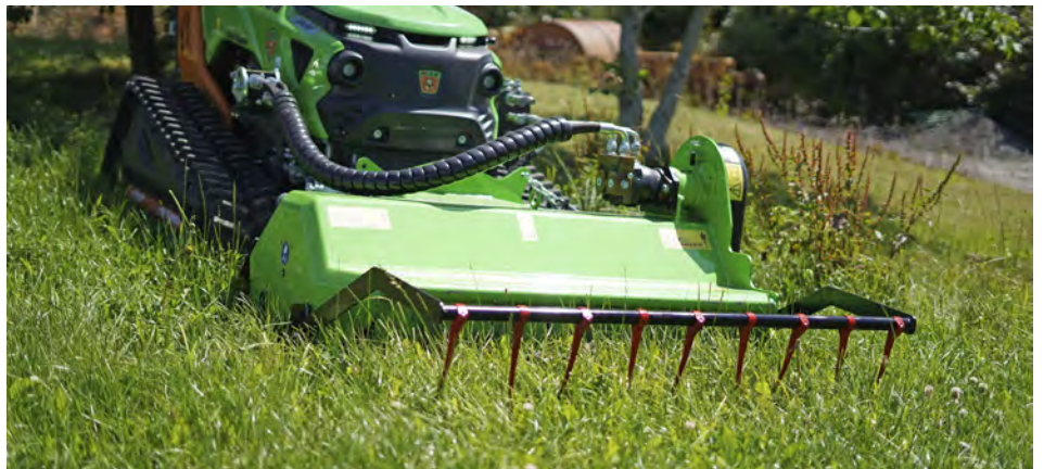
Beim INSECT-PROTECT-System des Landschaftspflege-Spezialisten VOGT handelt es sich ebenfalls um eine verstellbare Aufscheuchvor- richtung, die vor dem eigentlichen Arbeitswerkzeug angebaut wird. (Foto: Vogt GmbH)
