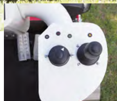
④ Fahrsteuerung mit elektrischem Regler für Geschwindigkeitsänderung. Hydraulikheber mit beweglicher Positionsregelung.
