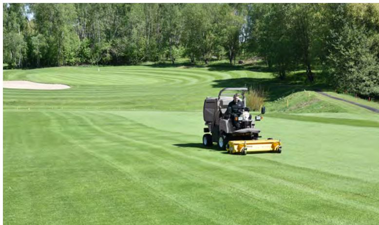
Abb. oben: Mit dem Mühling-Mulchgerät MU-COLLECT Vario ist alles möglich: Ein exaktes Mulchergebnis, eine perfekt vertikutierte Fläche und sauber aufgesammeltes Mulchmaterial. Erhältlich in den Arbeitsbreiten 1,4 und 1,6 m von 20 bis 40 PS oder hydraulisch angetrieben mit 30 bis 70 l/min. | Abb. unten: Außerdem wird gleichzeitig der Boden belüftet, so dass eine optimale Bewässerung sichergestellt ist.
