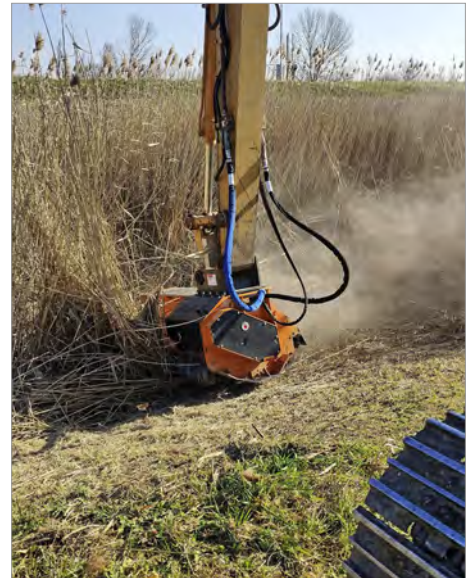
Der Mulcher kann mit verschiedenen Hubraumgrößen bei den Kolbenmotoren ausgestattet werden.
