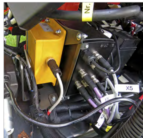
Der echte Hybridantrieb zeichnet sich dadurch aus, dass der 23 PS starke B&S-Vanguard-Motor (EU Stage 5) mit CAN-BUS-Steuerung einzig und allein dem Zweck dient, den 48-V-Stromgenerator anzutreiben. (Kleines Bild)
