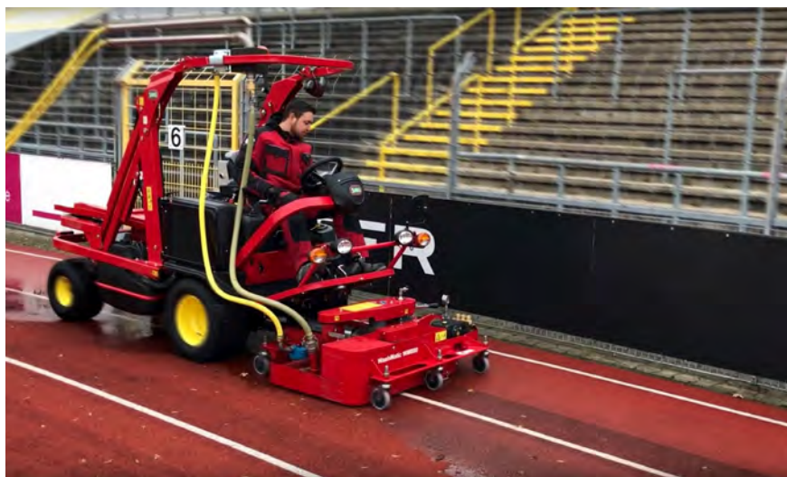
Das Frontanbaugerät der WM800 wird durch einen wassergekühlten 26-PS-Dieselmotor angetrieben.
