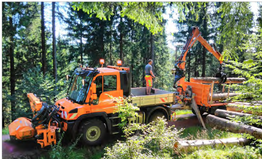
Durch die Kombination eines universellen Tandem-Dreiseiten-Kippanhängers mit Ladekran , der nicht auf das Zugfahrzeug aufgebaut werden muss, kann das ganze Jahr über Holz transportiert und jederzeit be- und entladen werden.
