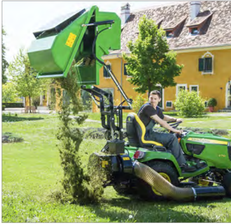
Die GS01 von Ecotech verfügt über eine leise, laufruhige und leistungsstarke Saugturbine mit exakt abgestimmtem Spiralgehäuse.
