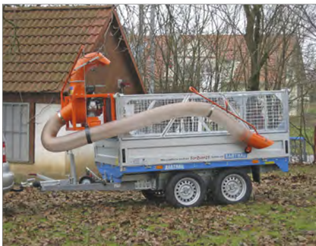
STOLL Laubverladegeräte vom Typ LVG 370/371 sind gewichtsoptimierte Laubsauger, die an die Ladebordwand von Anhängern oder Ladepritschen montiert werden.
