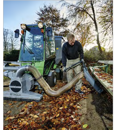
Zwei Turbinen gewährleisten bei der Park Ranger 2150 von EGHOLM , dass die Blätter vollständig zerkleinert und kompostierfähig werden.
