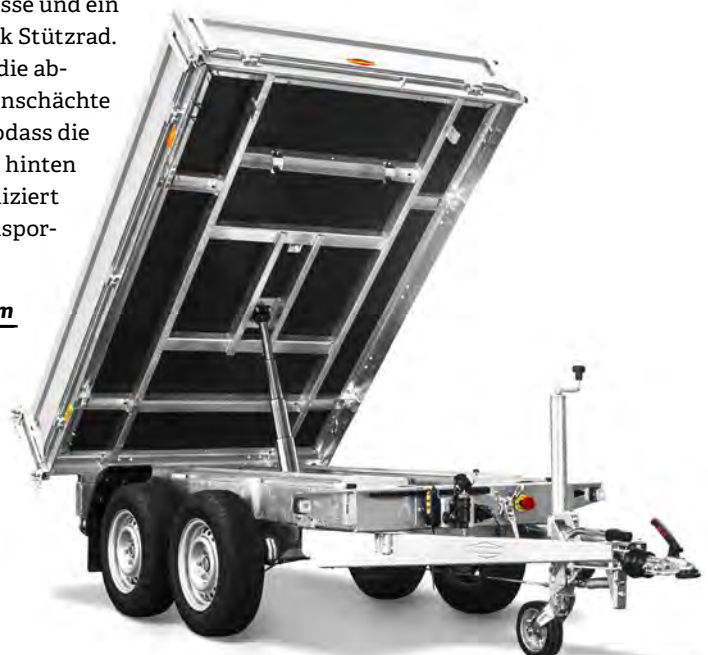
Die serienmäßige E-Hydraulik bietet eine Notausschalter und eine Nothandpumpe inklusive Ablassventil für ein sanftes Ablassen. (Abb. oben)
