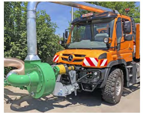
Auf einen Unimog aufgebaut: das Flaggschiff der HEN AG – die HEN-Laubverlademaschine .
