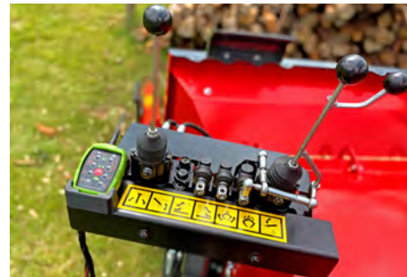
Der Häcksler Cheetah 30/80 bietet mit seinem 3,5-Tonnen-Pkw-Fahrgestell und eigenem Kran sehr große Flexibilität. (Links) Von dem übersichtlichen Bedienstand aus lässt sich der Kran mit 4,2 Meter Reichweite per Kreuzhebelsteuerung oder optional per Funk bedienen. (Rechts)
