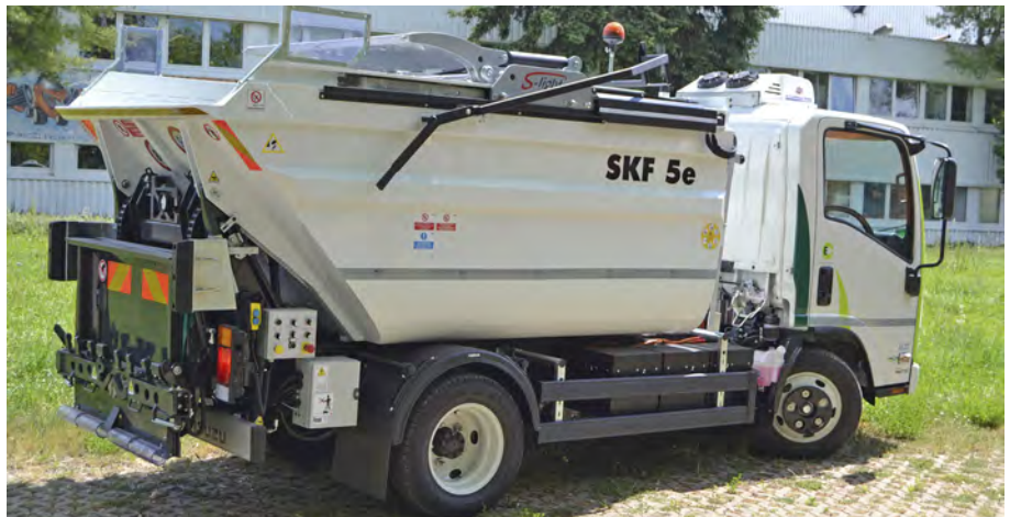
Mit dem Einstieg in die E-Mobilität stellt SKF zunächst ein neues batterieelektrisches Sammelfahrzeug (BEV) mit 5-cbm-Sammelwanne vor, das als ISUZU M55 full electric bzw. SKF 5e zukünftige Mülltonnen-Sammeltouren besonders umweltfreundlich, emissionsarm und leise absolvieren kann.
