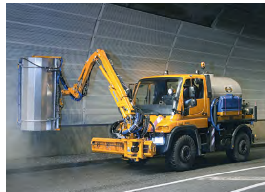
Unimog-Tunnelwaschgerät MFK 500-T im Einsatz.
