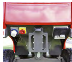
⑥ Einfacher Zugang zu den 220V Steckdosen, die sich direkt unter der Ladeplattform befinden.
