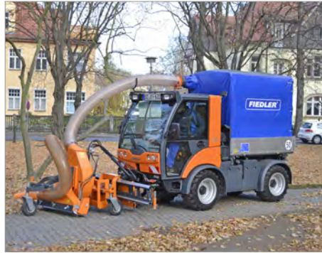
Mit einer Arbeitsbreite von 1200 mm eignet sich der FLAS 1210 von Fiedler zum Aufsaugen von Gras, Laub, Papier und anderem Leichtgut.
