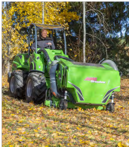
AVANTs Laubkehrmaschine 1300 ist zur Entfernung von Laub in Parks und auf großen Grundstücken geeignet.
