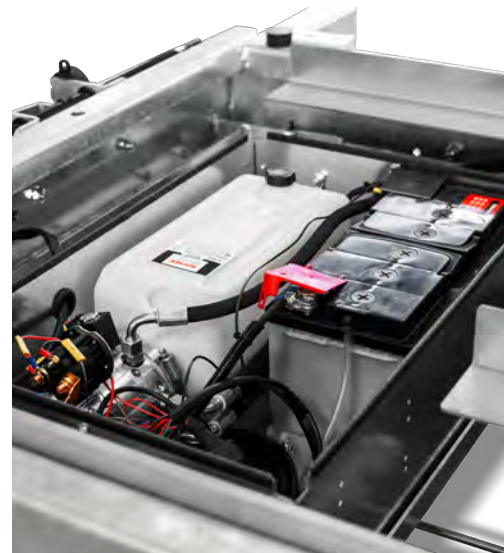
Die serienmäßige E-Hydraulik bietet eine Notausschalter und eine Nothandpumpe inklusive Ablassventil für ein sanftes Ablassen. (Abb. oben)
