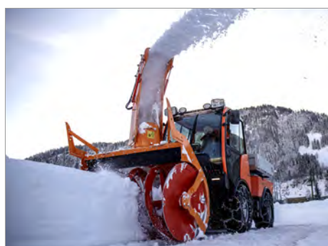
Kleinere Fräsen passen auch an kommunale Geräteträger. (Bild: Kahlbacher)
