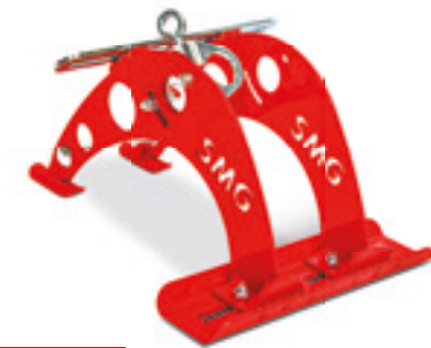
LineFix LF1 Andrückwerkzeug für eine feste Verbindung von Kunstrasen und Nahtband an Linien bei gleichzeitigem Einlegen der Linie; auch für Nähte einsetzbar
