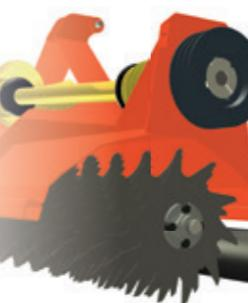
Der stabil konstruierte Rahmen und das zweiseitige mechanische Getriebe sorgen für eine lange Lebensdauer. Die Maschine hat eine Frontrolle, mit der die Arbeitstiefe auf maximal 50 mm eingestellt wird. Für einen ruhigen und effektiven Arbeitsvorgang sind die Vertikutiermesser spiralförmig auf der Sechskantachse montiert.
