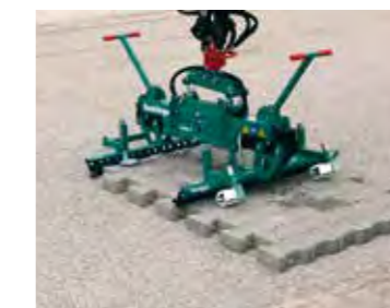
Pflastergreifbacken am Multi-Steingreif zum Verlegen ganzer Lagen
