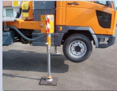
Sonderausstattung Hubfunktion ohne Abstützung. Volle Nutzung der schmalen Durchfahrtbreite des Multicar bei gleichzeitig bis zu 12,5 m Arbeitshöhe und 8,20 m seitlicher Reichweite. Zugang auch zu extrem engen Aufstellorten.
