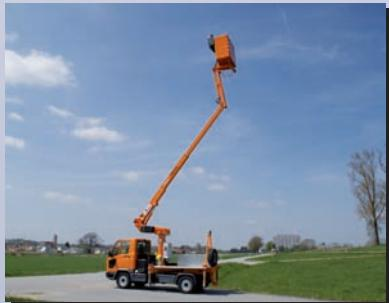
Ergonomischer Zustieg über Schwingtür in den isolierten Arbeitskorb mit 220 kg Korblast. Alle Bewegungen einschließlich Stützen-funktionen sind serienmäßig vom Arbeitskorbaus zu bedienen.
