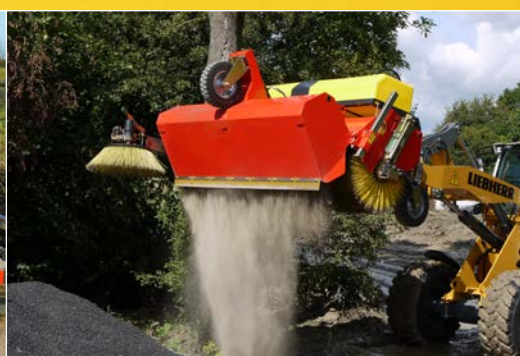
Hydraulische Entleerung des Sammelbehälters
