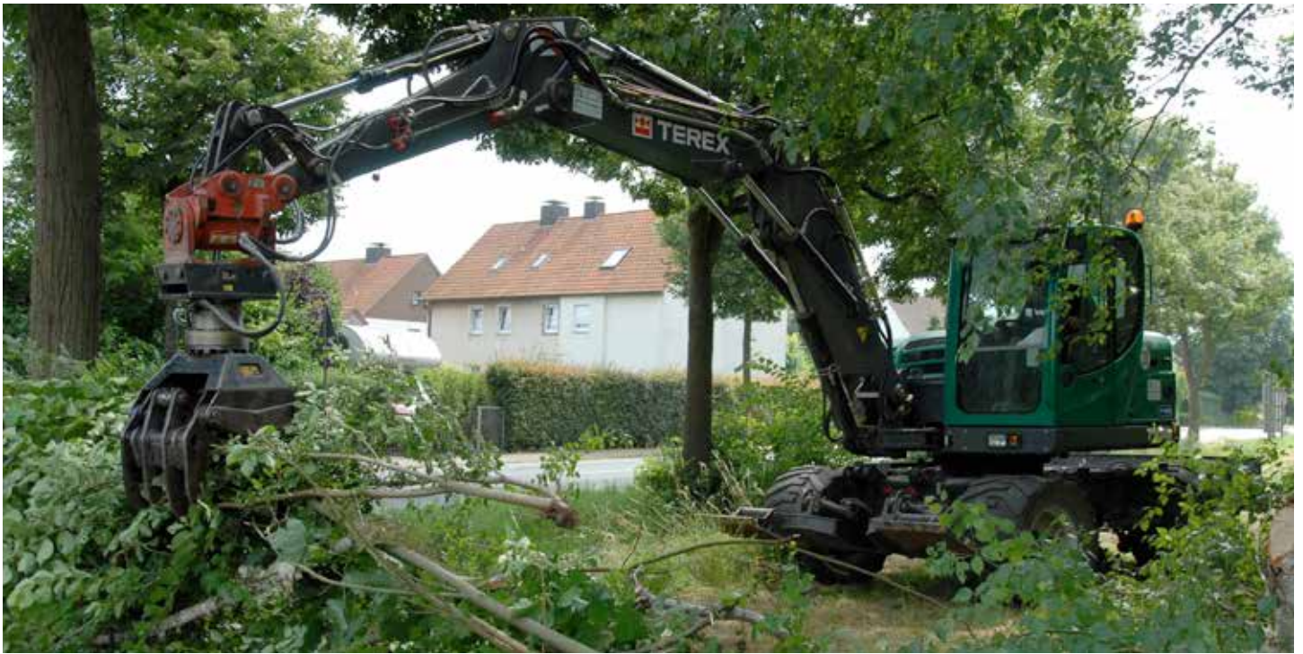
Die Breitreifen verleihen dem TW110 einen besonders sicheren Stand und reduzieren den Bodendruck auf unebenem Gelände.
