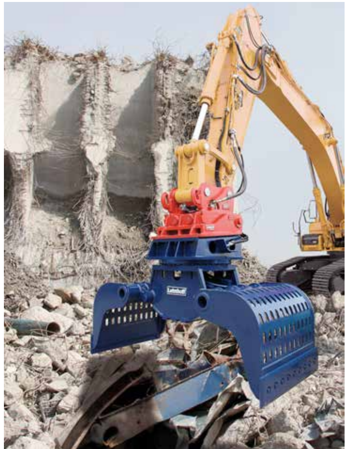
Die neuen Sortiergreifer von Lehnhoff überzeugen durch hohe Schließ-, Dreh- und Haltekräfte.
