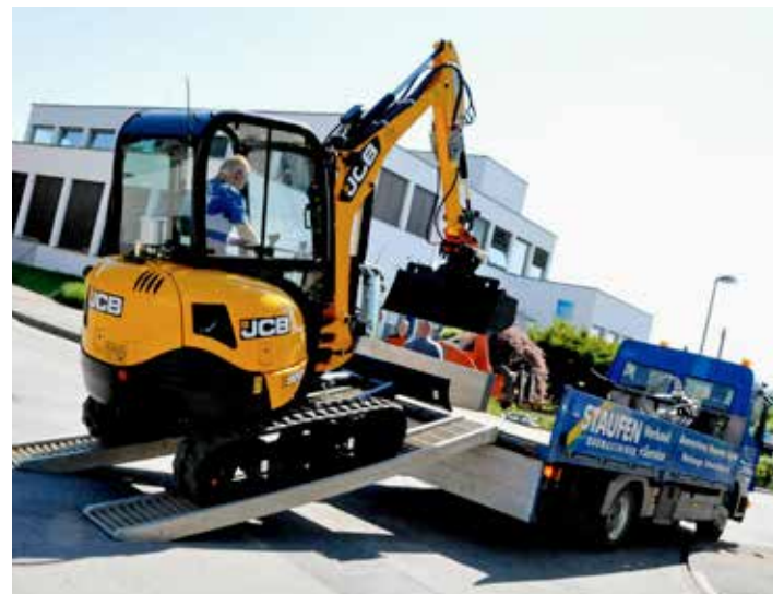
Mit seinen 2,8 Tonnen kann der JCB 8026 CTS problemlos - sogar mit Pkw-Anhänger - von Einsatz zu Einsatz befördert werden.
