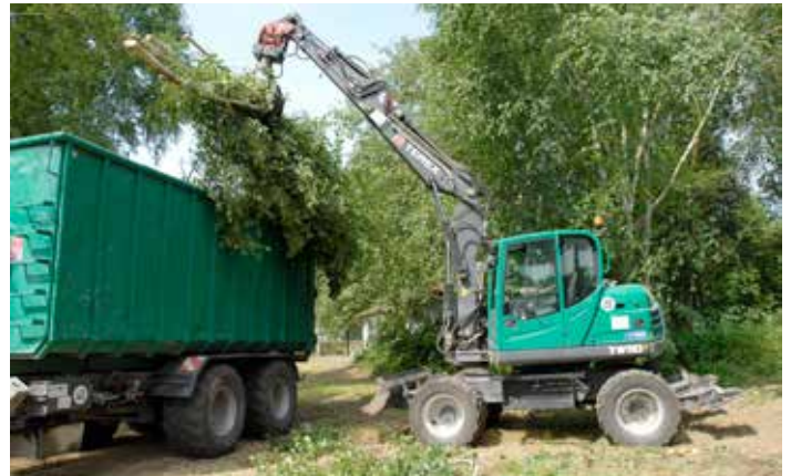
Der Terex Mobilbagger TW110 belädt auch ohne Probleme sehr große Container oder LKW mit hohen Ladekanten.
