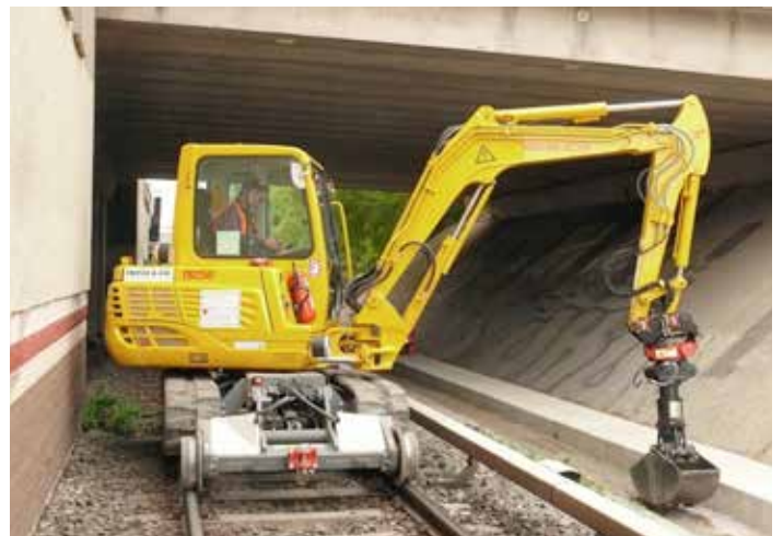
Aufgrund seiner kompakten Abmessungen von 1,85 m Breite und 2,51 m Höhe ist der Takeuchi TB 250 ZW auch für Arbeiten in engen Bereichen bestens geeignet.
