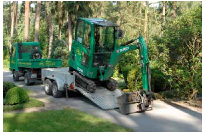
Das verstellbare Laufwerk sowie Abmessungen und Gewicht des TC20 erlauben einen unkomplizierten Transport auf kleinen Anhängern.
