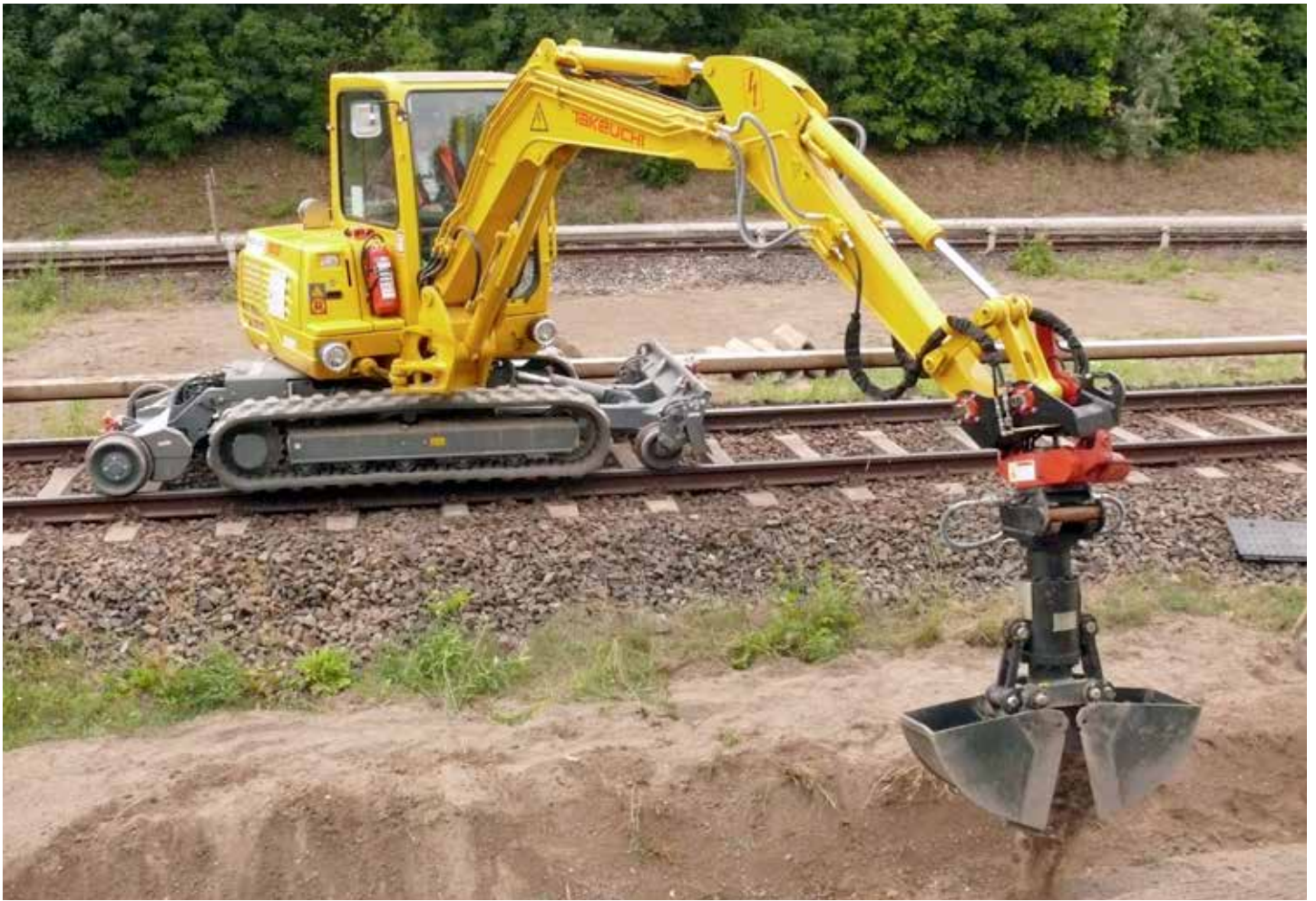
Angetrieben von einem 28,4 kW/38 PS Motor, übernimmt der 5,8 t schwere Zweigegebagger Takeuchi TB 250 ZW problemlos Arbeiten, die sonst von größeren Baggern ausgeführt werden.
