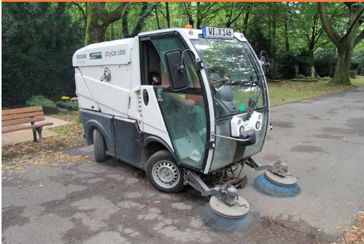
Der Dienstleister Knettenbrech + Gurdulic FullService wählte seine Kompaktmaschine mit optionaler Vierradlenkung. Damit kann sie spielend auf schmalen Friedhofswegen wenden.
