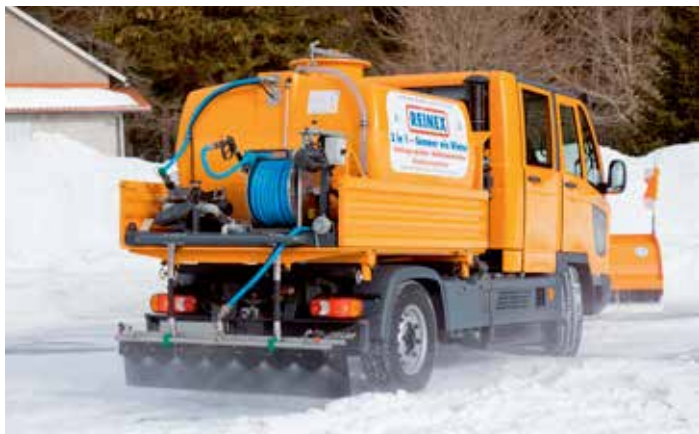
Der Multicar FUMO mit Doppelkabine und Solesprüher sorgt für eisfreie Straßen und Wege.
