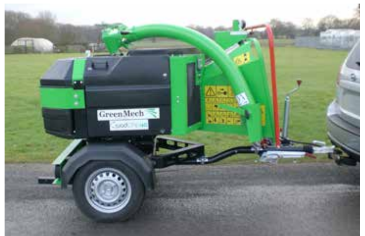
Der QuadChip 160 von GreenMech wiegt unter 750 kg und ist mit Führerschein Klasse B transportierbar.
