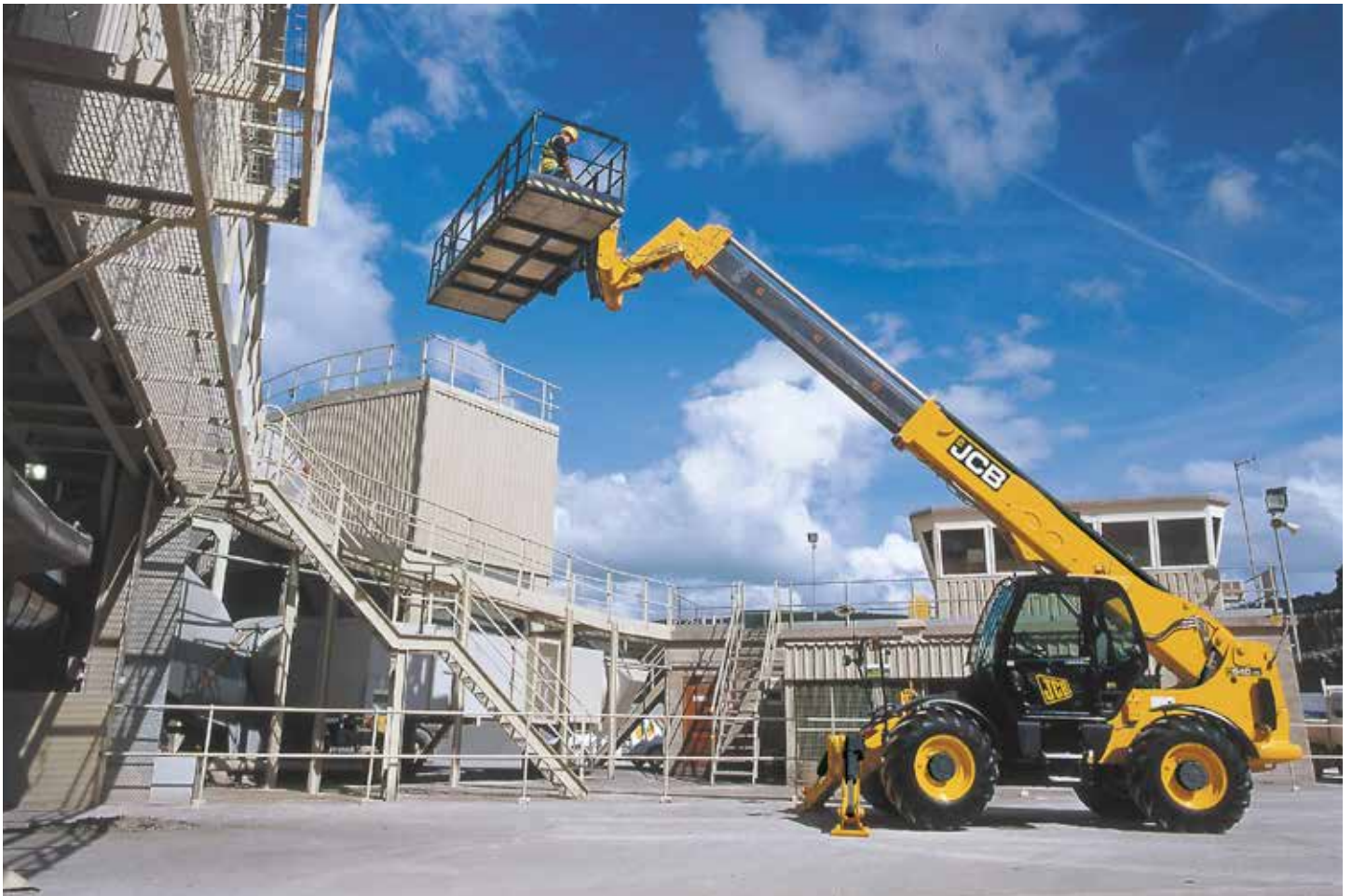
Der JCB Teleskoplader 540-170 hievt bis zu vier Tonnen bis zu 17 Meter hoch.
