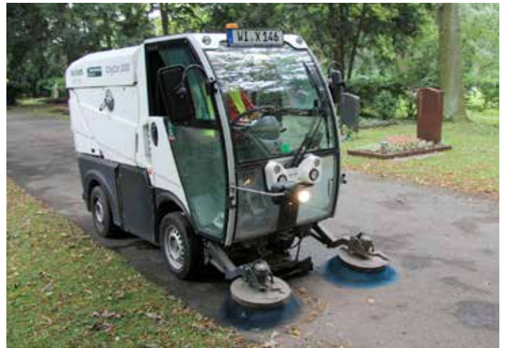
Die zwei geschobenen, anfahrsgeschützten Tellerbesen sind unabhängig breitenverstellbar. Damit entwickelt die CityCat 1000 eine hohe Kehrleistung bei flexibler Kehrbreite.
