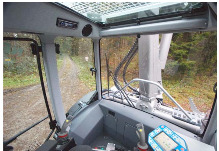
Pfanzelt XXL Kabine mit um 340° drehbarem Bedienerstand.
