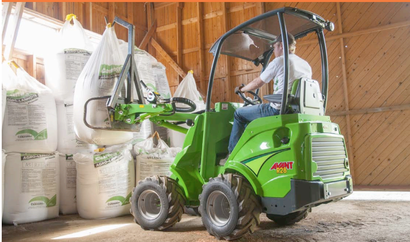
Der AVANT-Multifunktionslader R28, das kleinere der beiden R-Modelle, ist eine robuste Maschine, bei der der Fahrer auf dem Hinterwagen sitzt.
