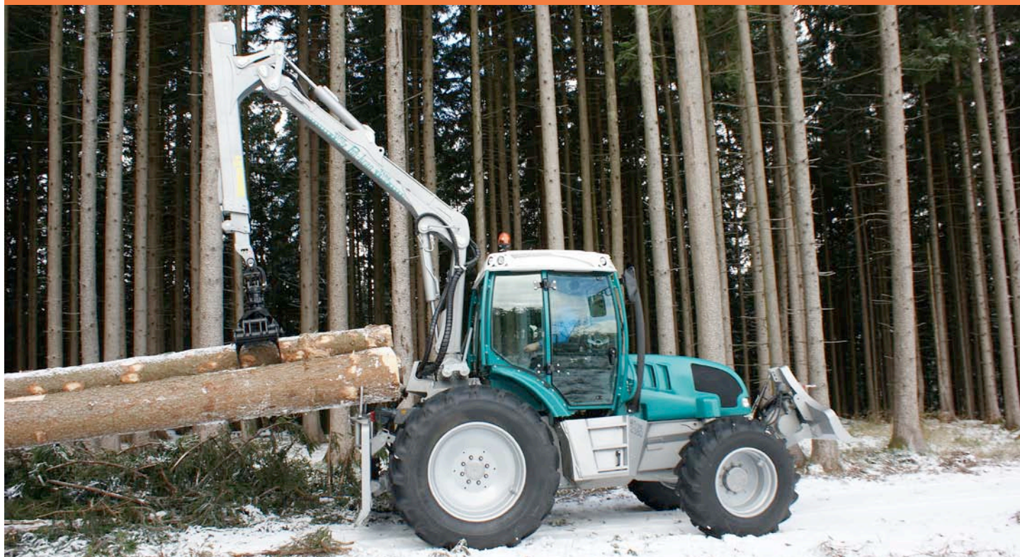
Durch die Anordnung der Kabine in der Fahrzeugmitte entsteht direkt über der Hinterachse der Aufbau Raum für Kran und Seilwinde.
