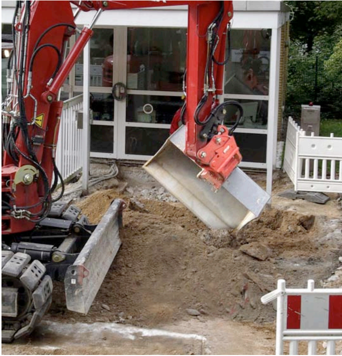
Mit 2x70° Schwenkwinkel bietet der Lehmatic Powertilt höchste Flexibilität auf der Baustelle.
