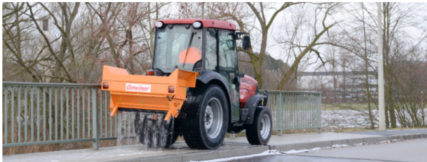
Die Streuautomaten der neuen Baureihe Tracon R haben ein Behältervolumen von 200 Litern Trockenstoff.
