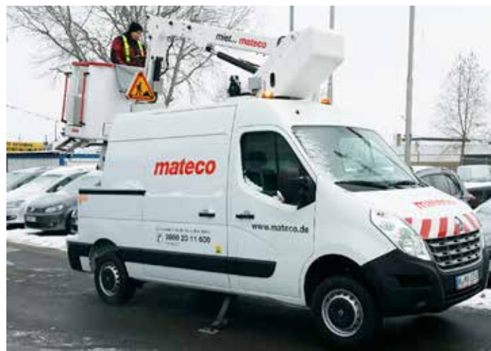
Der Arbeitsbühnenvermieter mateco hat eine neue LKW-Arbeitsbühne mit Hybrid-Antrieb der Hubeinrichtung im Mietpark – die LT 135 K D/E.
