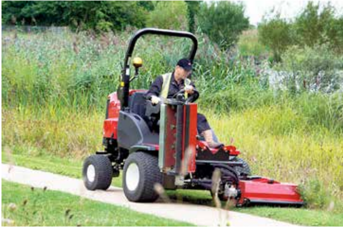
Zum Mähen von Wegerändern lässt sich beim LT-F3000 jedes Mähwerk auch bequem hochklappen.
