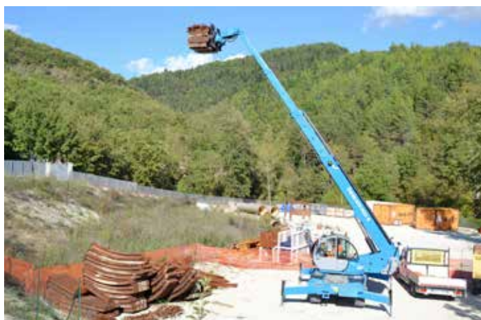
Der Genie® GTH™-5021 R beim Transport von 2 Tonnen schweren Paletten mit Stahlträgern zum Stolleneingang.
