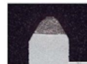
Laser-Beschichtete Schnittkante nach dem Test
