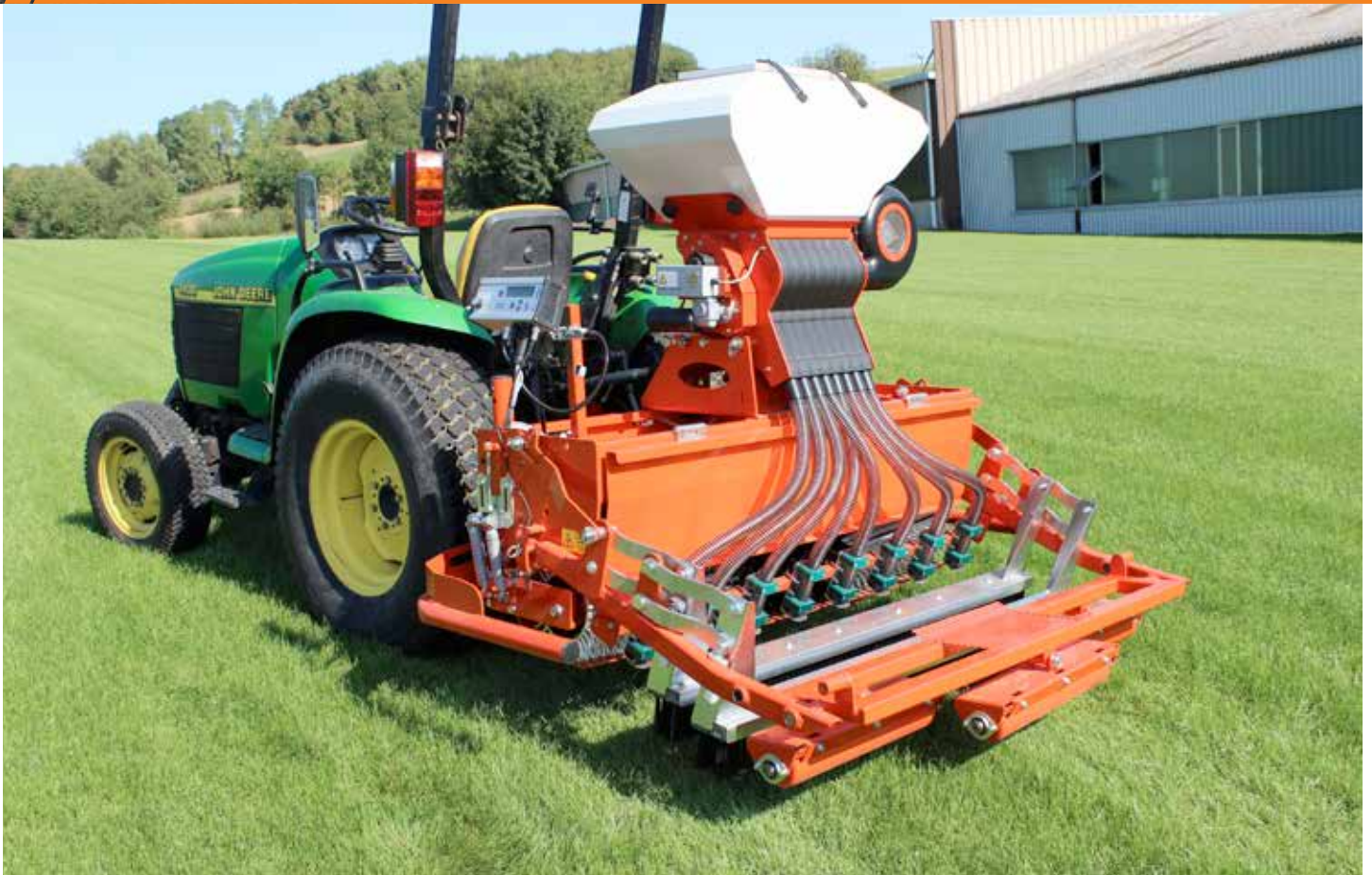
Perforieren, Sähen, Einbürsten, Walzen: Mit der neuen Terra Float Air übernimmt eine einzige Maschine alle Einzelaufgaben in einem Arbeitsdurchgang.
