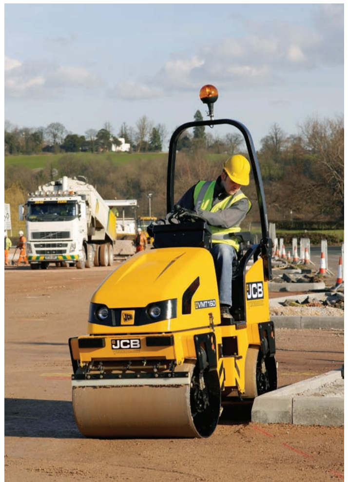
Die VMT160 mit 17 kW / 23 PS und einem Einsatzgewicht von 1.600 bis 1.800 kg besticht mit uneingeschränkter Seiten- und Kantenfreiheit.
