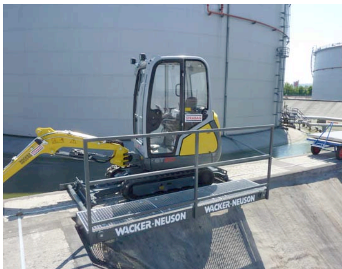
Der umgebaute Kompaktbagger ET20 von Wacker Neuson im Einsatz am Tanklager.
