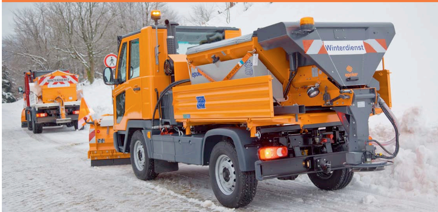
Der Igloo S2400 (hier auf Multicar M31) fasst bis zu 950 Liter Trockenstoff.
