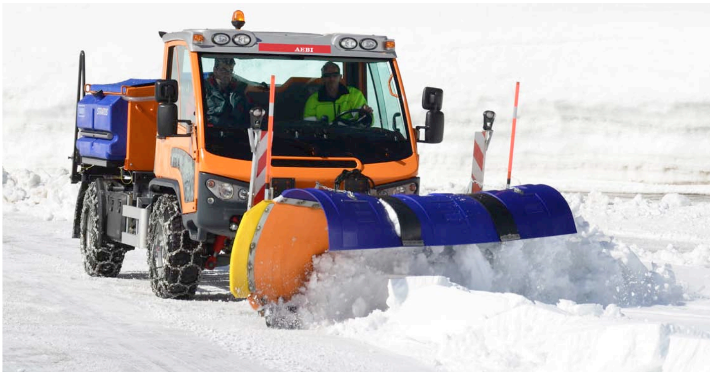
Aebi VT450 Vario im Kommunaleinsatz bei der Schneeräumung.
