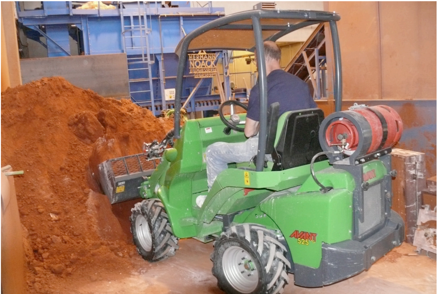
Der AVANT Multifunktionslader 525 LPG ist gasgetrieben, arbeitet ohne Dieselemissionen und ist so bestens für alle Indoor-Einsätze geeignet.
